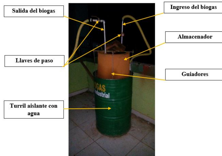
Figura 10. Almacenador de Biogás.
