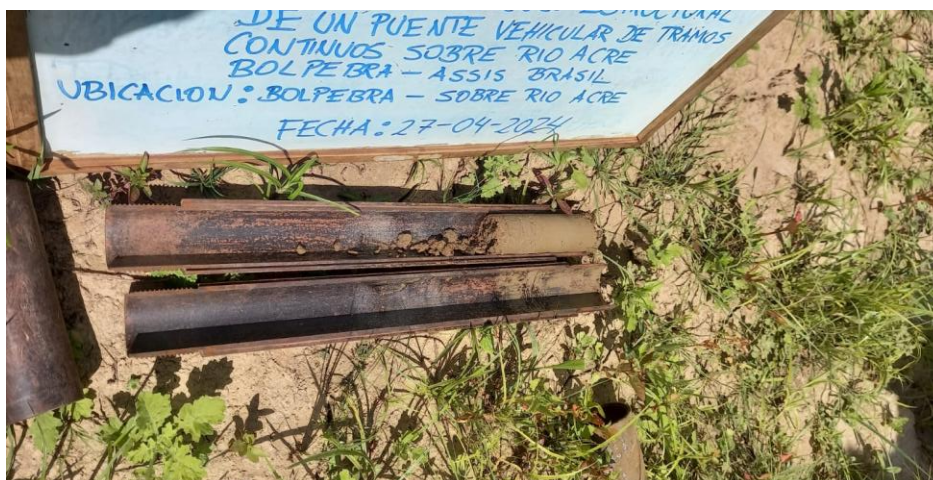
Figura 3.18 Toma de muestras inalteradas
