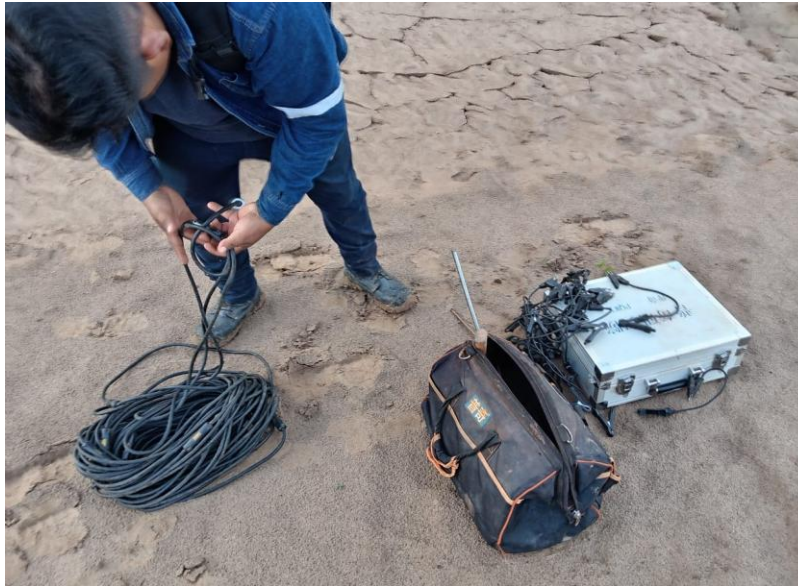
Figura 3.20 Instalación de equipo de sondeo eléctrico vertical (S.E.V.)
