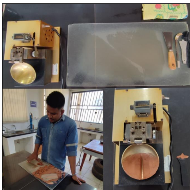
FIGURA 3.4 Ensayos de límites líquido y plástico en laboratorio
