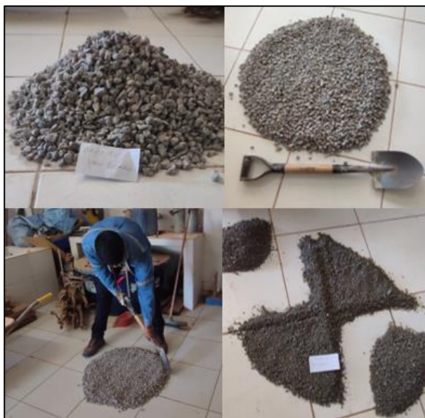
FIGURA 3.6 Cuarteo manual del agregado grueso
