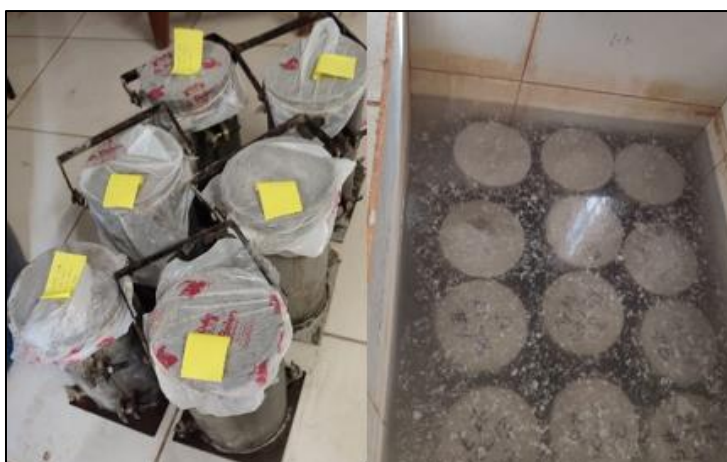
FIGURA 3.9 Curado inicial y final de probetas cilíndricas
