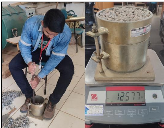
FIGURA 3.7 Ensayo de peso unitario compactado en laboratorio
