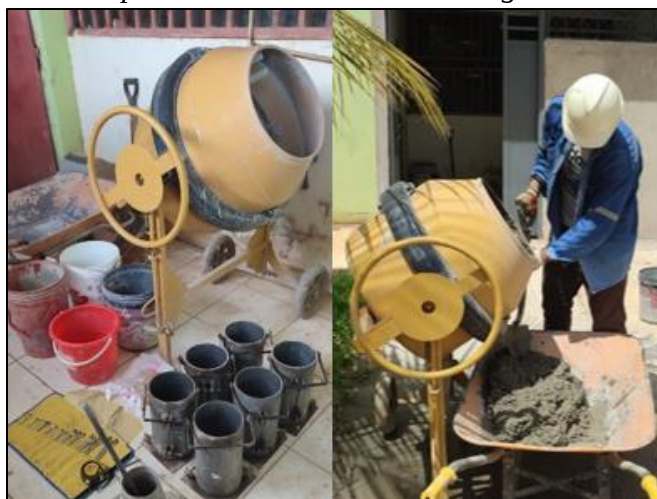
FIGURA 3.8 Elaboración de probetas cilíndricas de hormigón
