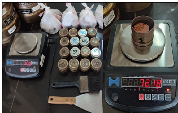
ENSAYO DE CONTENIDO DE HUMEDAD
