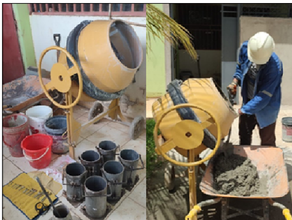
FABRICACIÓN DE HORMIGÓN PARA PROBETAS
