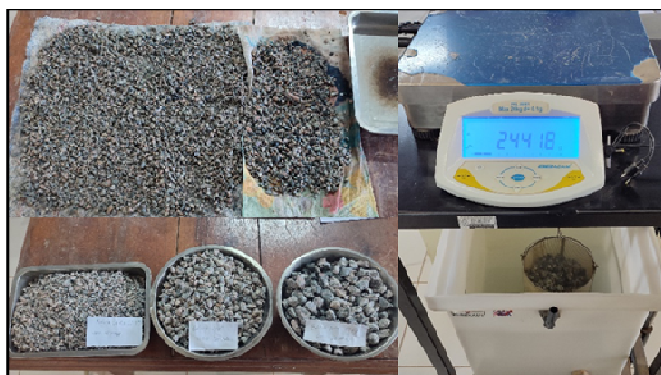
GRAVEDAD ESPECIFICA Y ABSORCION (A. GRUESO)
