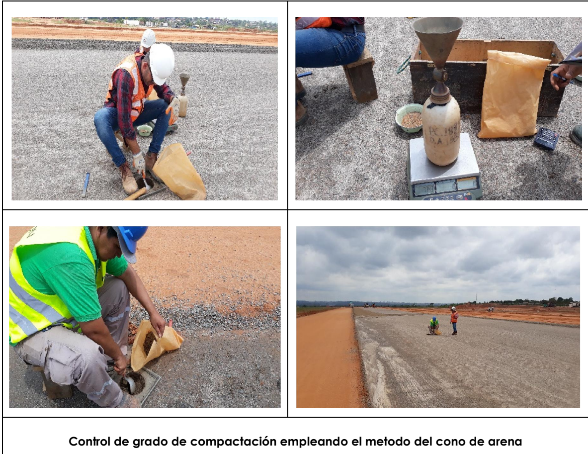
ILUSTRACIÓN 30. CONTROL DE DENSIDADES
