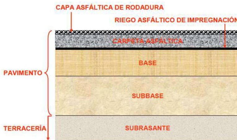
ILUSTRACIÓN 33. SECCIÓN ESTRUCTURAL TÍPICA DE UN PAVIMENTO ASFÁLTICO
