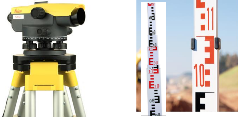
Imagen 4. 4. Equipo de nivelación Leica NA324 2.0mm.
