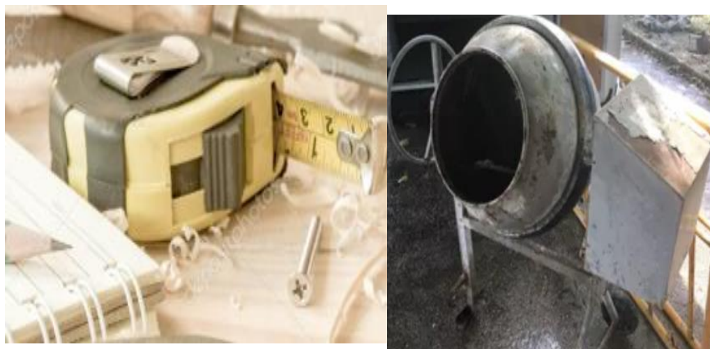
Imagen 4. 23. Hormigonera y cinta métrica.
