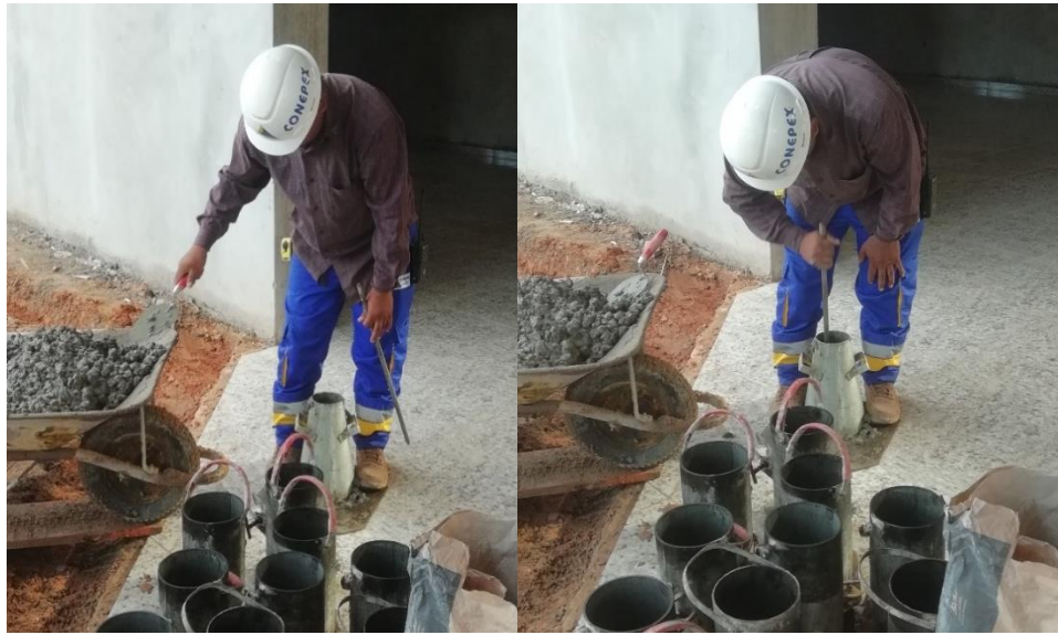
Imagen 4. 26. Elaboración de la prueba del cono de Abrams.
