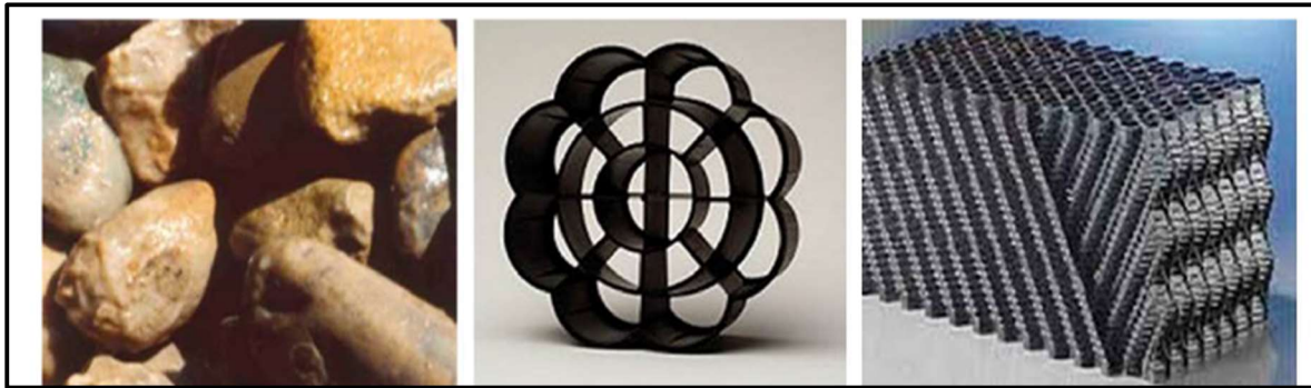
Materiales de soporte empleados en Filtros Percoladores
