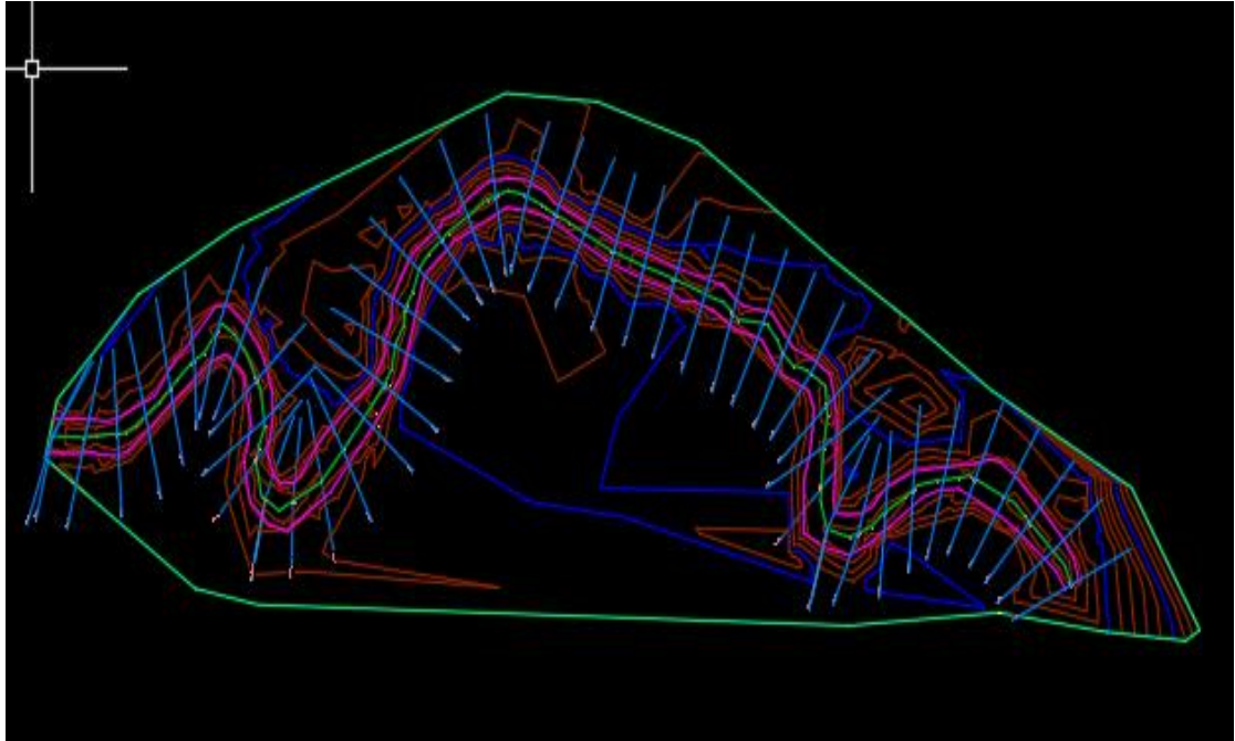
Figura 4-16 Sección transversal del Arroyo Bahía cada 10 metros aguas arriba y aguas abajo
