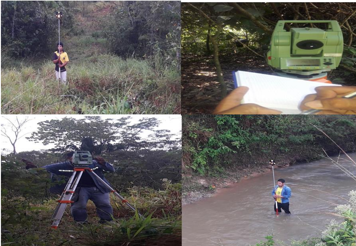
Foto N° 3 levantamiento Topográfico con estación total “Julio” año 2019
