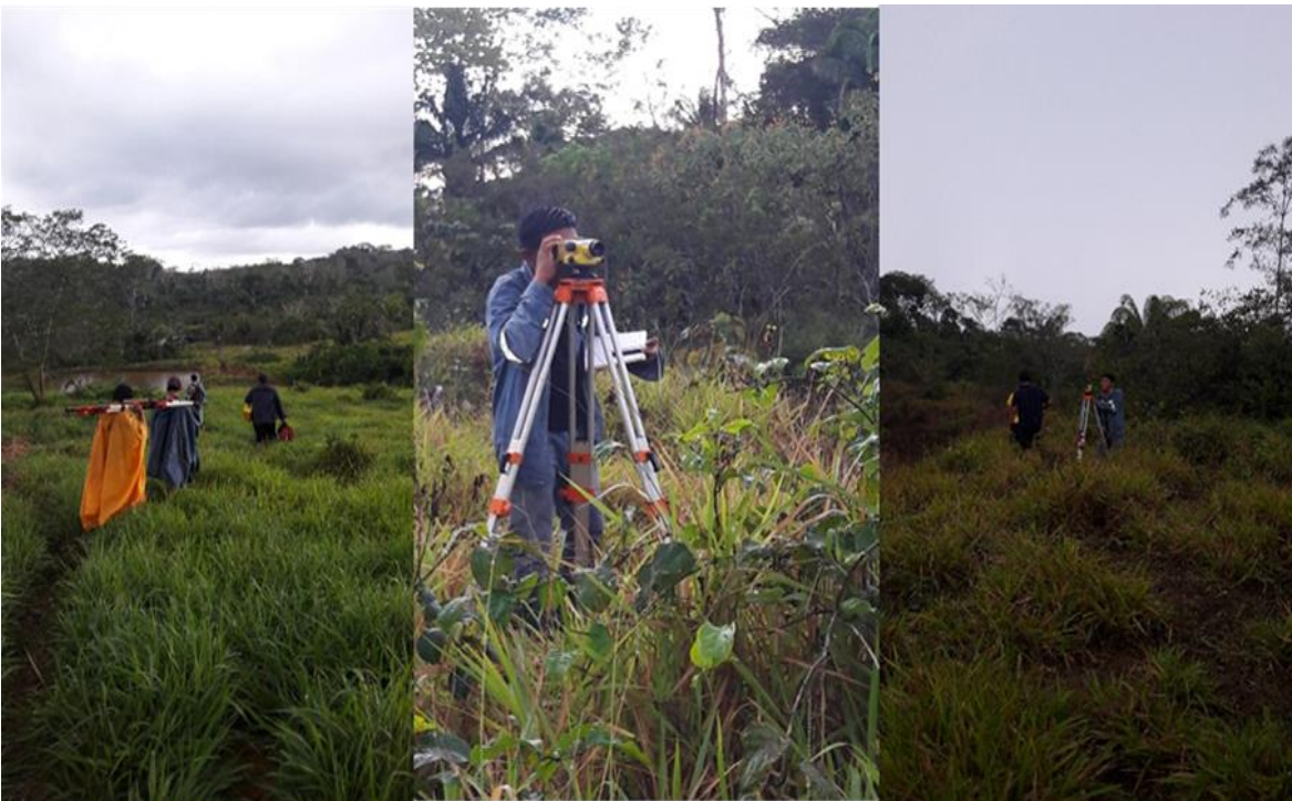
Foto N° 2 instalación del equipo de nivel de ingeniero “Julio” año 2019
