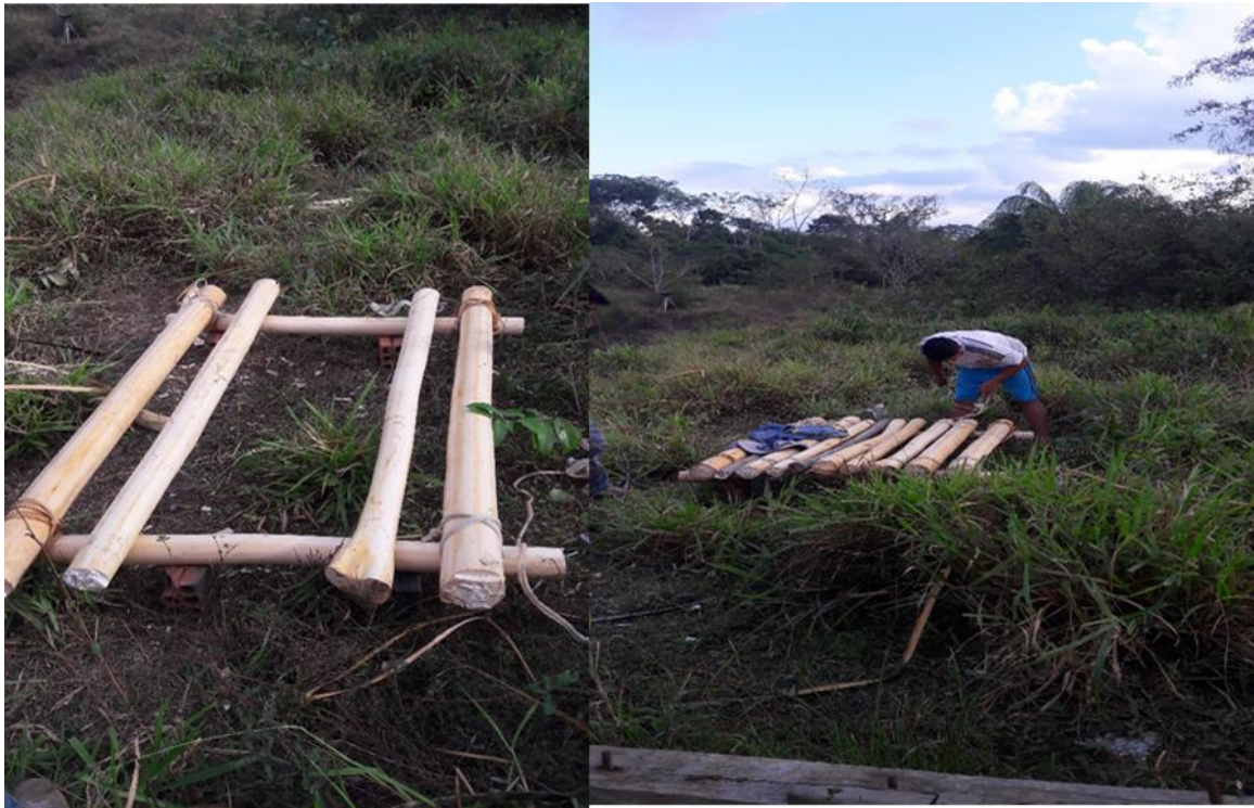
Foto N° 5 Creación de un objeto Flotante para tomar puntos en el centro del arroyo Bahía “Julio” año 2019
