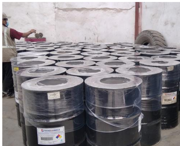
Figura 53. Almacenaje del cemento asfáltico
