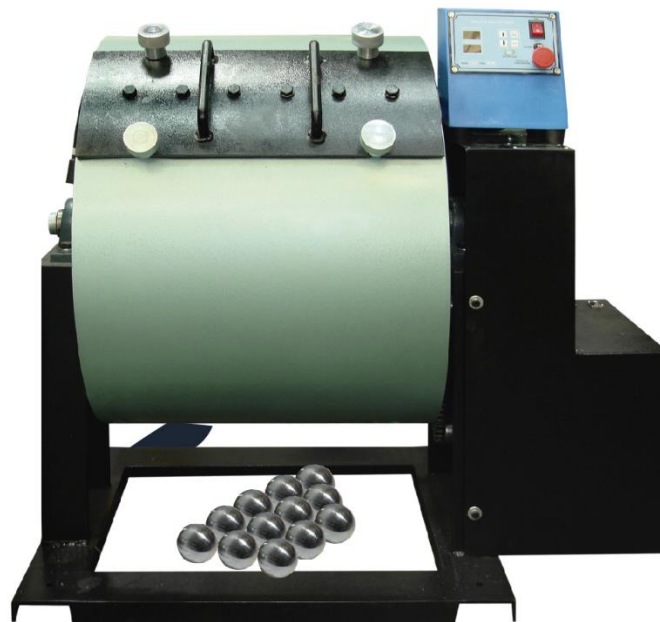
Figura 92. Máquina de Los Ángeles para ensayos de abrasión Fuente: Equipos de laboratorio.
