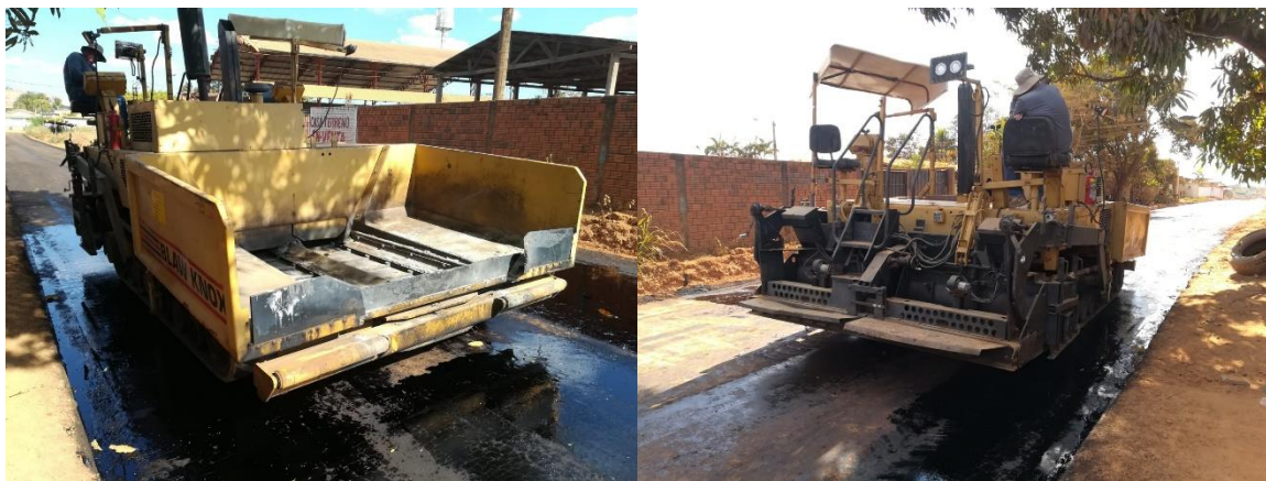
Figura 12. Terminadora de asfalto BLAW KNOX PF-5510 Fuente: Elaboración propia
