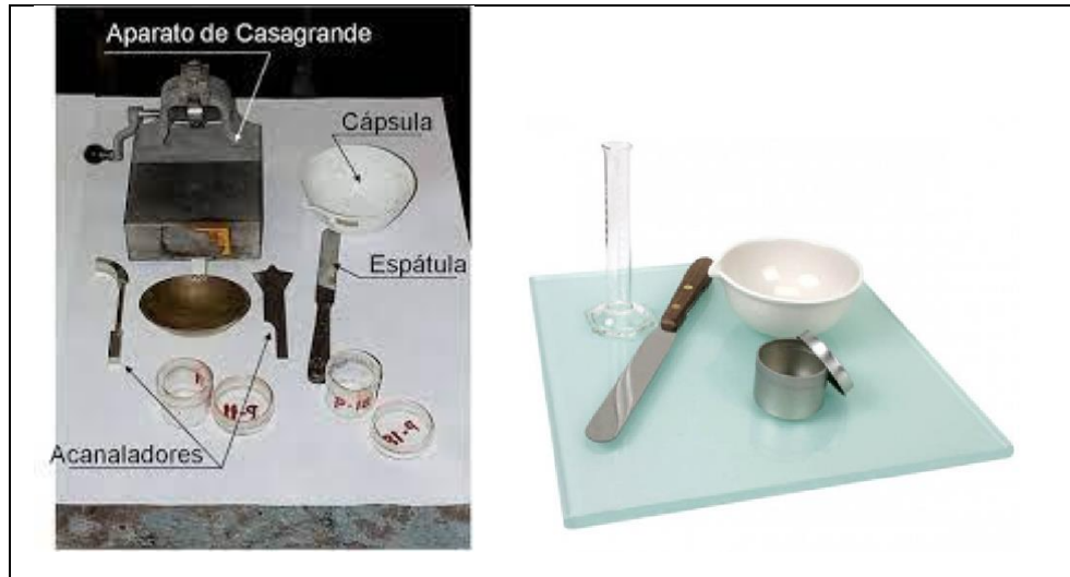
Figura 81. Equipos de laboratorio para los ensayos de límite líquido y plástico Fuente: PyS equipos de laboratorio
