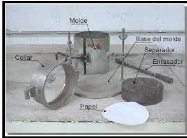
Figura 82. Equipos para realizar los ensayos de compactación Fuente: Manual de ensayo de suelos.
