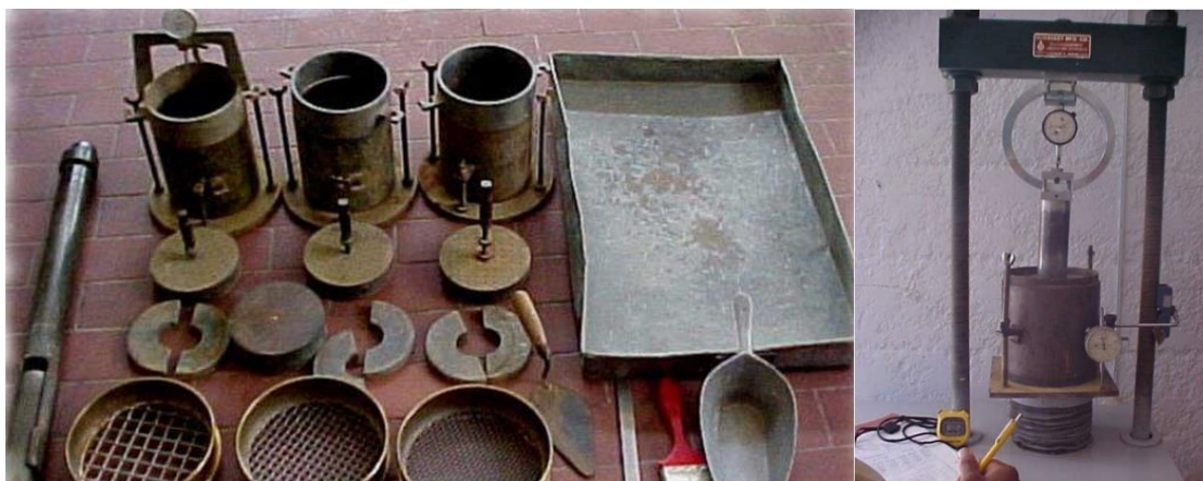
Figura 83. Equipos y herramientas para el ensayo C.B.R.
