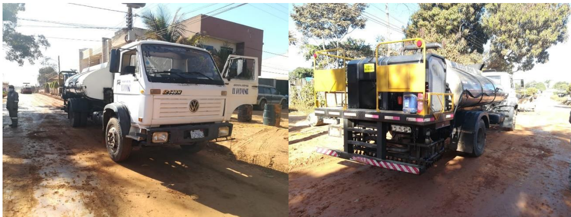
Figura 11. Cisterna de riego de asfalto VOLKSWAGEN 12-140H Fuente: Elaboración propia
