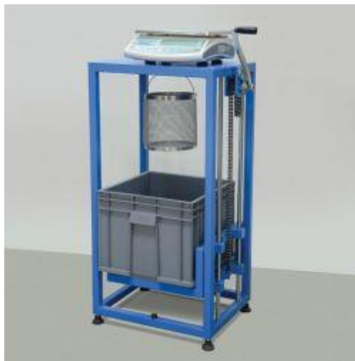
Figura 88. Forma de pesado de muestra para ensayo de densidad sumergida Fuente: Equipos para ensayos de materiales - UTEST
