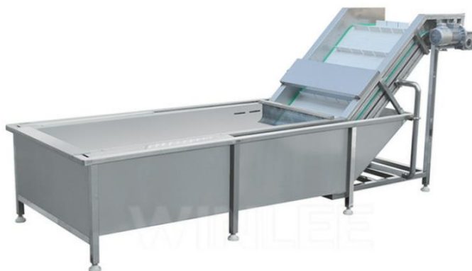
Figura 32. Máquina lavadora de frutas por inversión e inspiración Fuente: www.winlee.com
