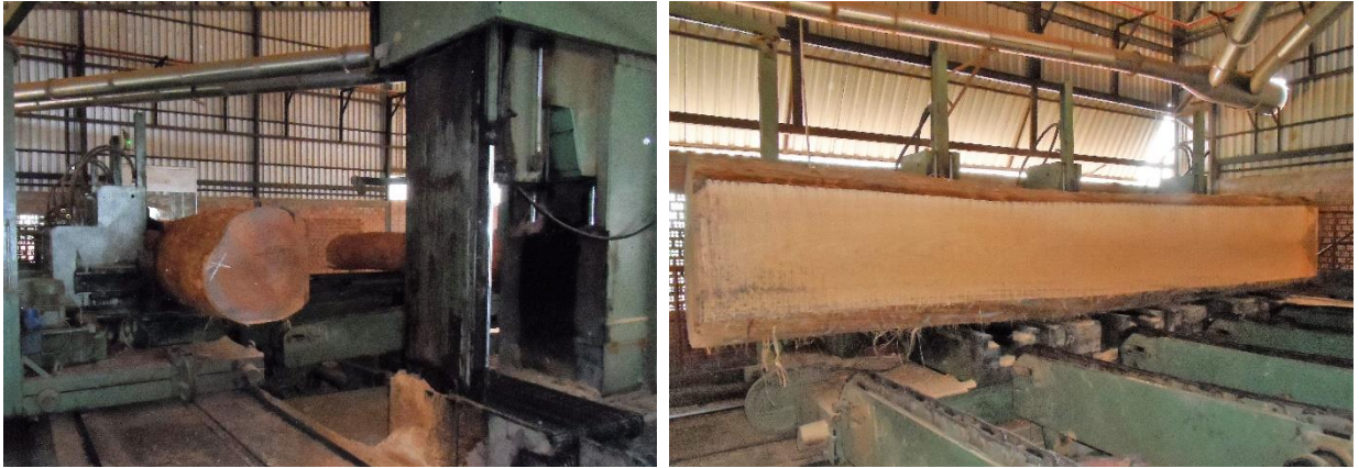
Fotografía: 3.2 Proceso De Escuadrado Y Seccionamiento De Las Trozas. (Fotografía Propia)
