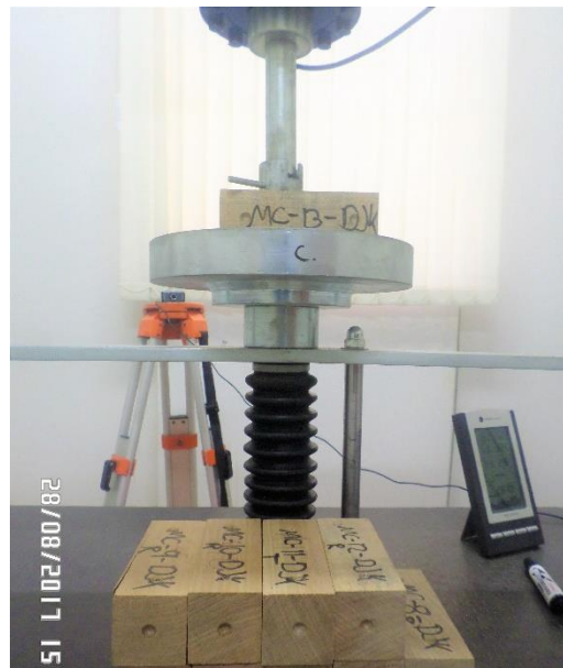
Fotografía: 4.6 Disposición De La Probeta Para El Ensayo de Dureza (Fotografía Propia)
