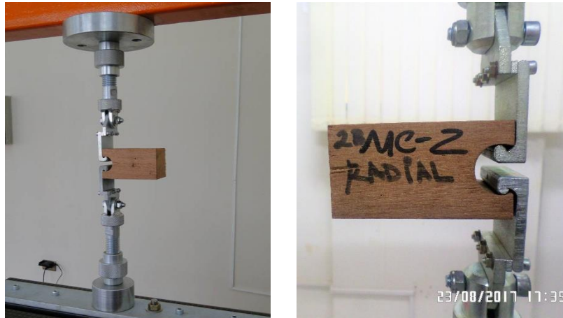
Fotografía: 4.8 Disposición de la probeta para el ensayo de Clivaje (Fotografía Propia)
