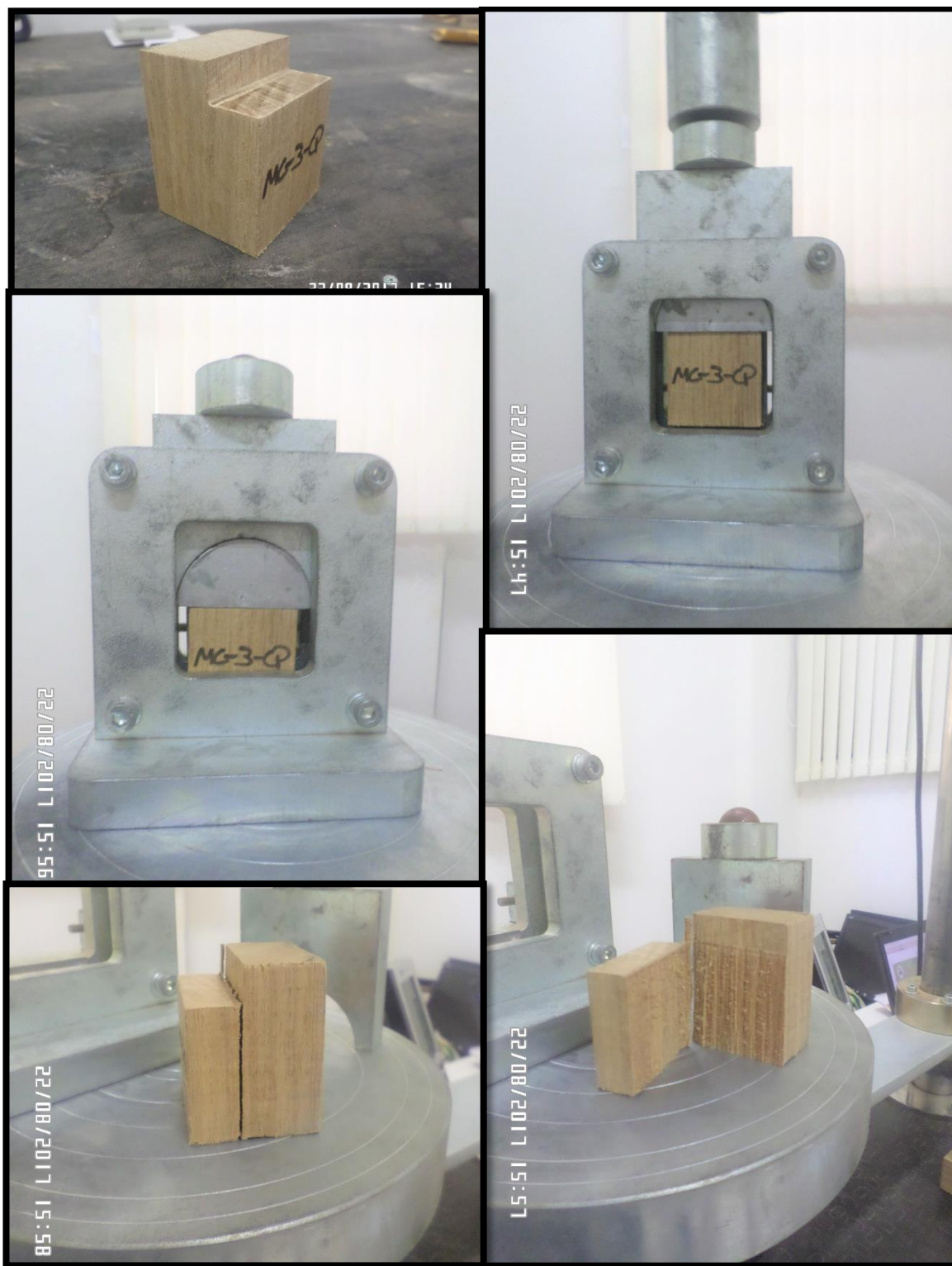
Fotografía. 11 Ensayo De Corte Paralelo a las Fibras. Desarrollo del Ensayo. Falla por corte
