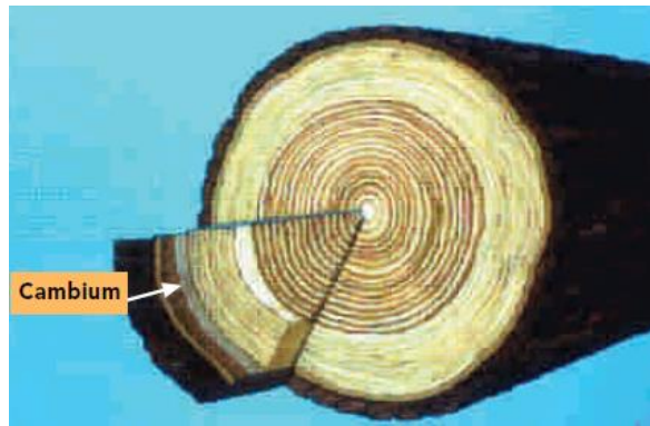
Figura: 2.3. Sección Transversal De Un Tronco. Cambium. (CORMA, La construcción de viviendas de madera, S/f)
