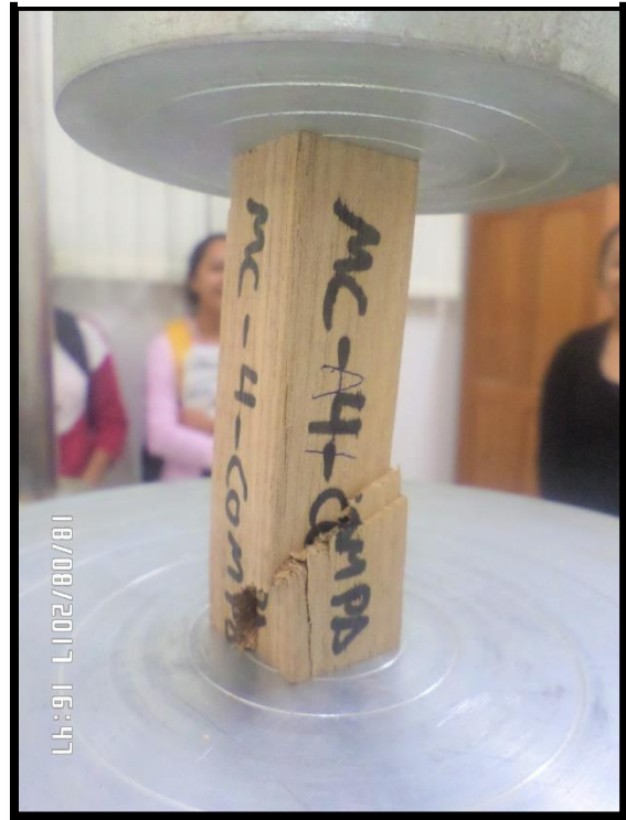
Fotografía. 9 Ensayo De Compresión Paralela a las Fibras. Falla por Cizallamiento
