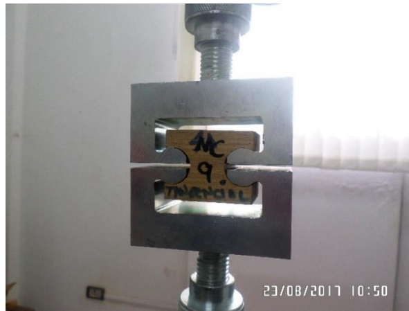
Fotografía: 4.10 Probeta de Tracción Perpendicular a las Fibras Ubicada En Dispositivo De Ensayo (Fotografía Propia)
