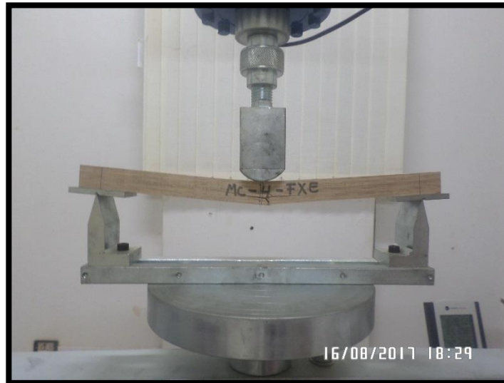
Fotografía. 6 Ensayo De Flexión Estática. Se Observa Falla Por Tensión Transversal a las Fibras
