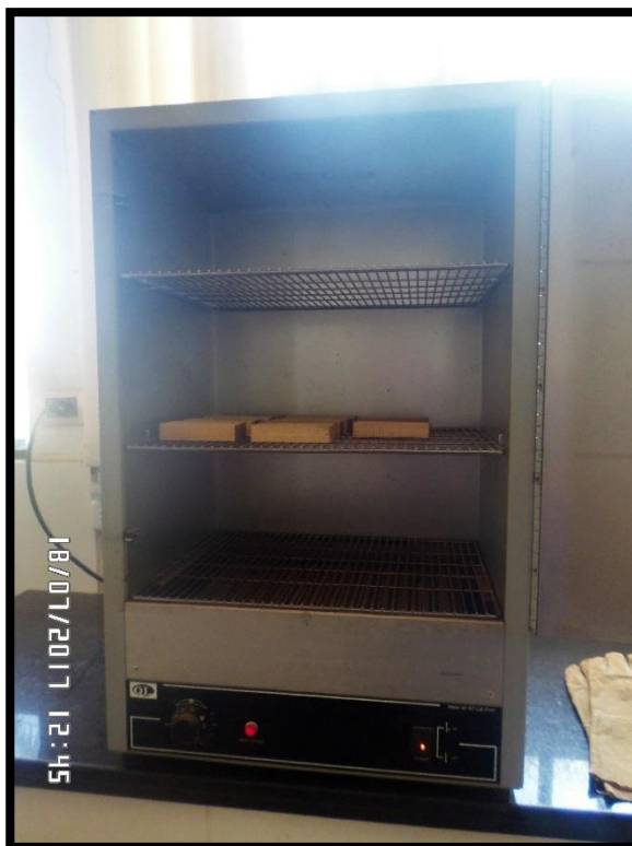
Fotografía. 2 . Secado de Probetas Para Determinar Contenidos de Humedad
