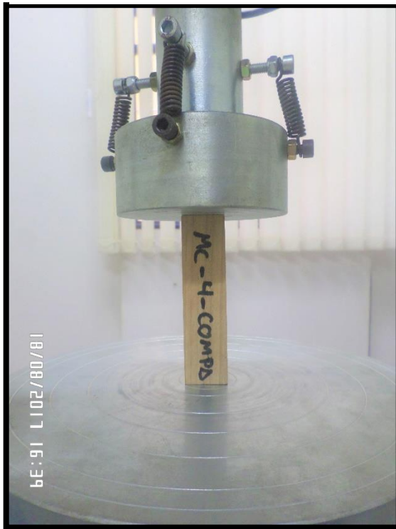
Fotografía. 8 Ensayo De Compresión Paralela a las Fibras. Disposición de Probeta
