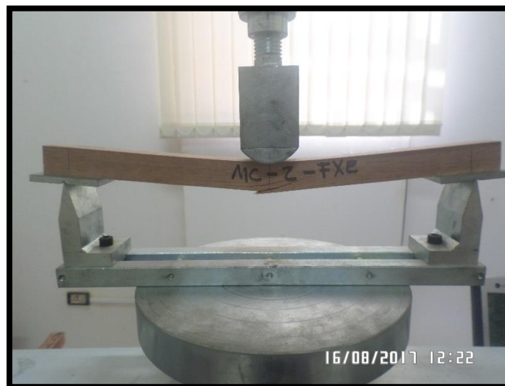
Fotografía. 6 Ensayo De Flexión Estática. Se Observa Falla Por Tensión Transversal a las Fibras
