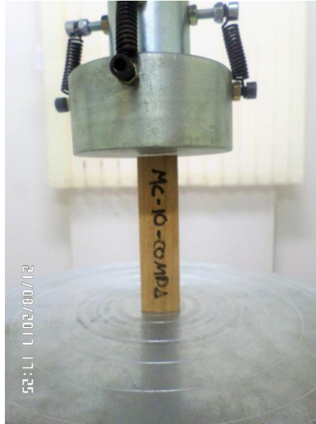
Fotografía: 4.4 Disposición De La Probeta Para El Ensayo Compresion Paralela a las Fibras (Fotografía Propia)
