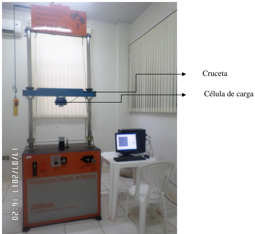
Fotografía: 4.1 Descripción de Máquina para ensayos en madera JDBlab. (Fotografía Propia)
