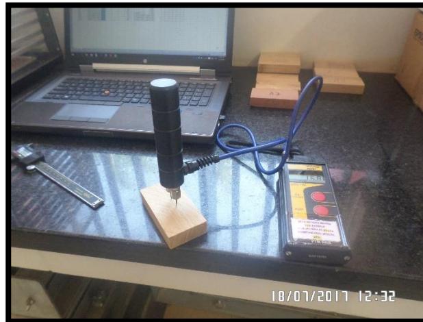
Fotografía. 3 Comparación De Humedades Con Ayuda De Un Xilohigrometro
