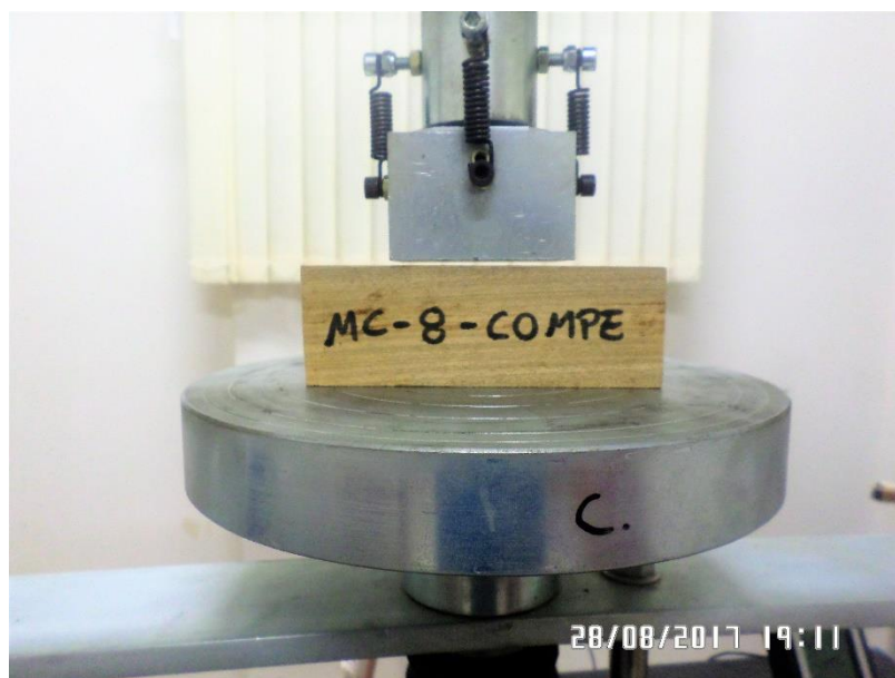
Fotografía: 4.5 Disposición De La Probeta Para El Ensayo Compresión Perpendicular a las Fibras (Fotografía Propia)
