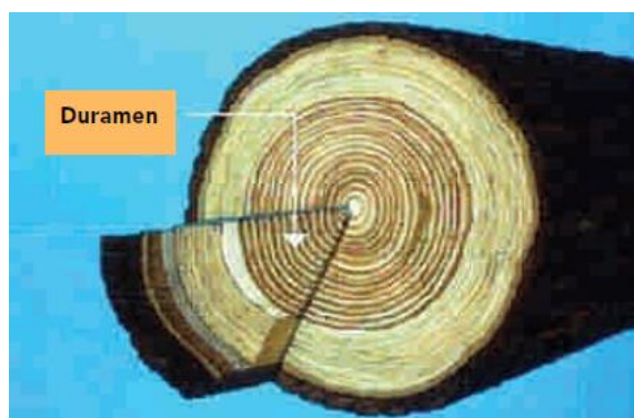
Figura: 2.5. Sección Transversal De Un Tronco. Duramen. (CORMA, La construcción de viviendas de madera, S/f)
