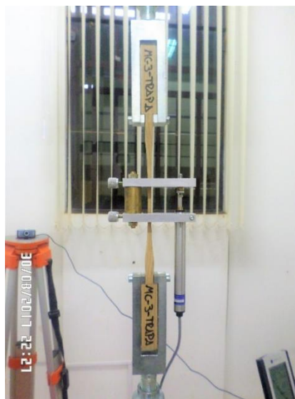
Fotografía: 4.9 Probeta Ubicada En Dispositivo De Ensayo Traccion Paralela a las Fibras (Fotografía Propia)
