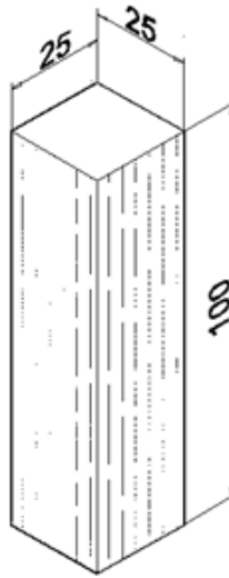
Figura: 4.4. Dimensiones De Probeta En Mm. Compresión Paralela A Las Fibras. (JDBlab)
