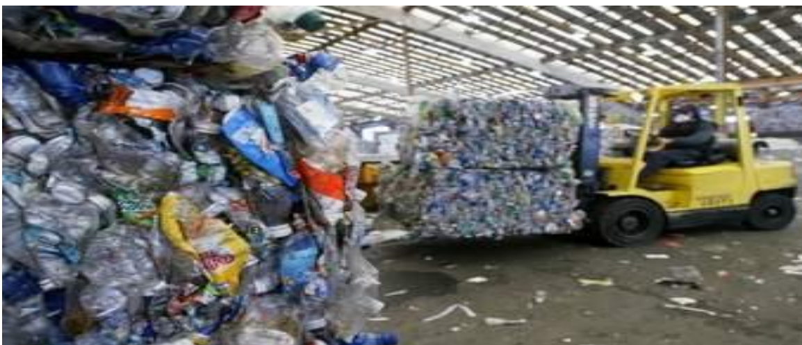
Figura 12 Compactación de los residuos sólidos
