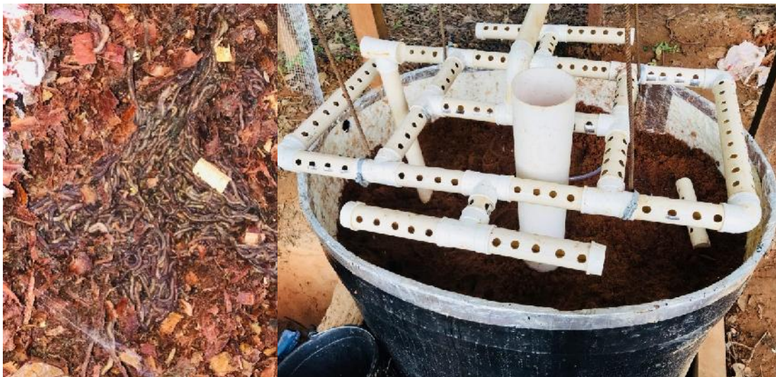
Foto N°6 Lombrices Rojas Californianas y tubería de riego por sistema de goteo al lombrifiltro
