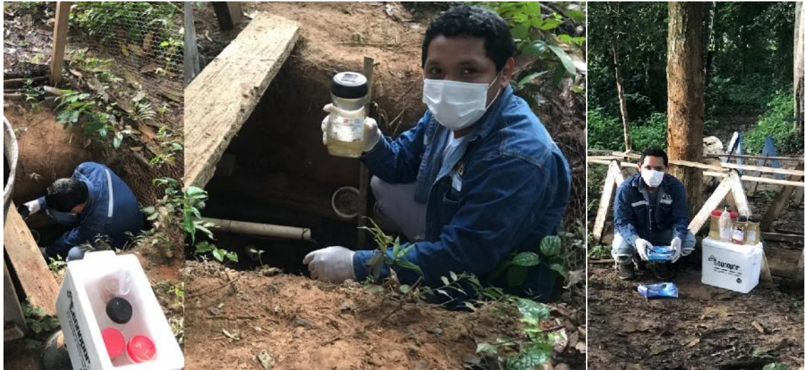
Foto N°9 Toma de Muestra puntual en el efluente del lombrifiltro de agua tratada
