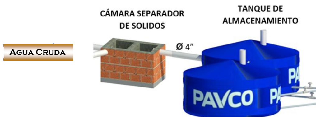
Figura 3.6. Tanques de almacenamiento
