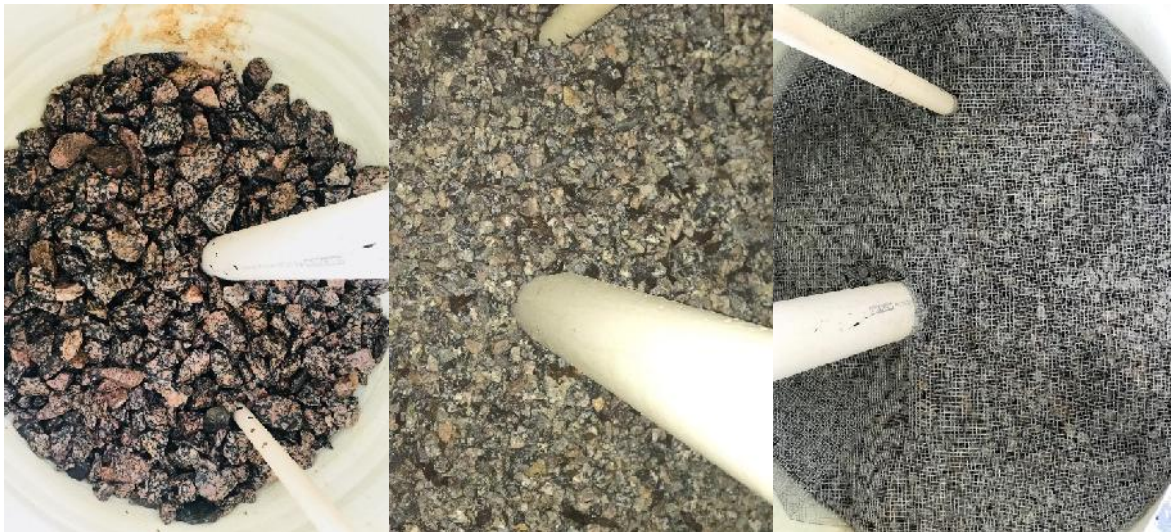
Foto N°4 Capas de Piedra, BRITA y malla de 2 mm electrosoldado
