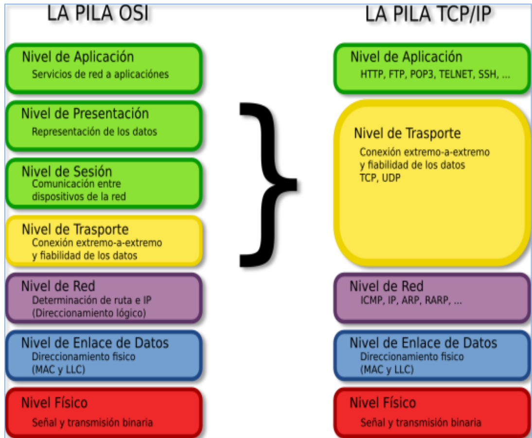
Figura 2.2 Pila OSI Vs Pila TCP/IP
