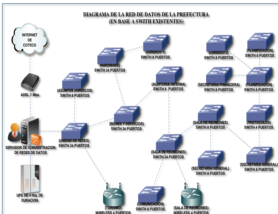
Figura 3.4: Diagrama de red en base a Switch Fuente: Elaboración Propia
