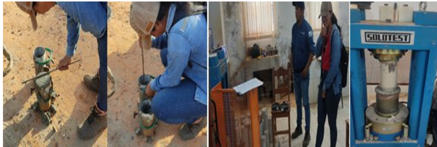
Figura 3.22 Ensayo de Resistencia a la Compresión
