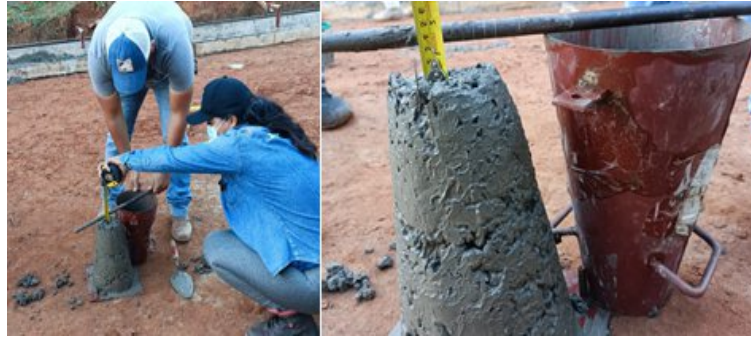
Figura 3.21 Asentamiento del Hormigón Fresco
