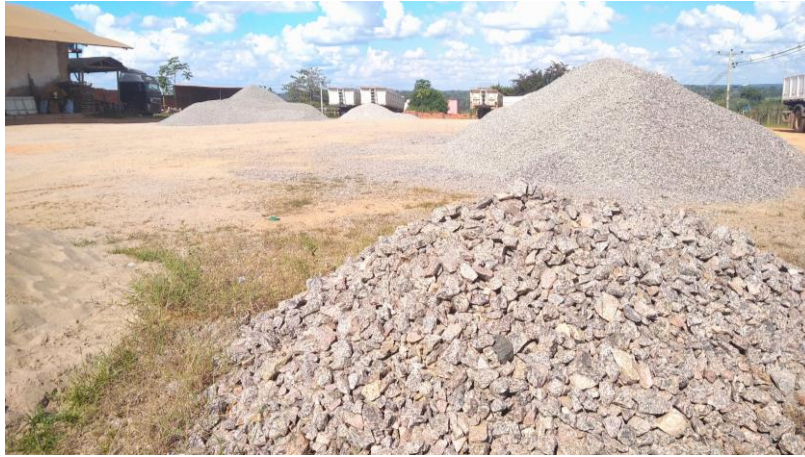
Área de acopio de piedra chancada
