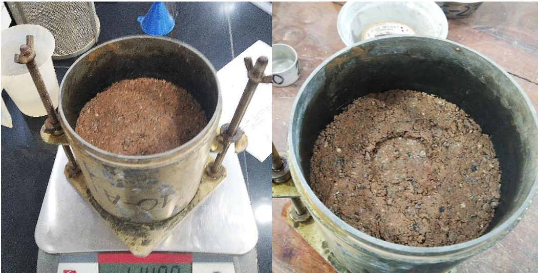
Moldes de CBR de la dosificación “conforme a los requerimientos” antes y después del prensado
