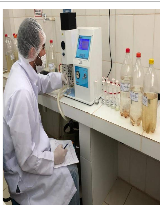
Fotómetro de llama. Para medición de sodio y potasio.
