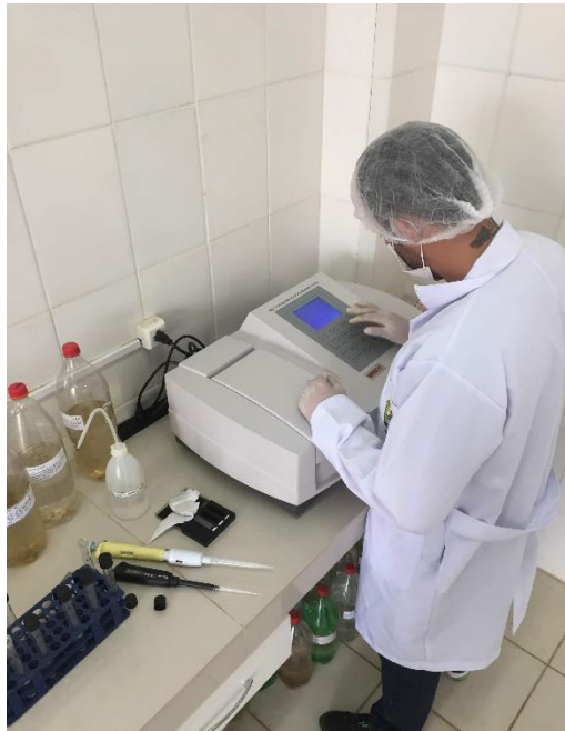
Spectrofotometro UV-Visible. Para medición de Sulfatos y Nitratos.
