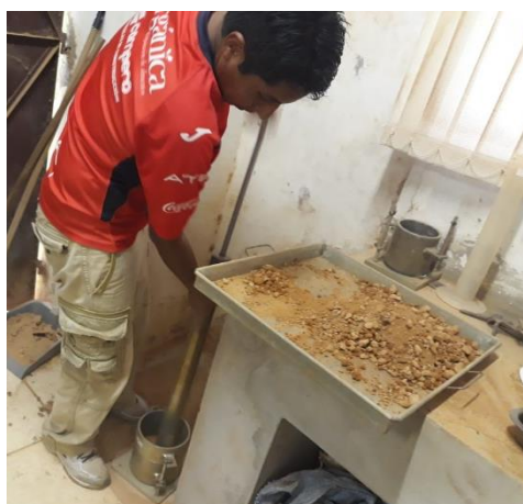
Figura 3.5 Ensayo de Proctor modificado
