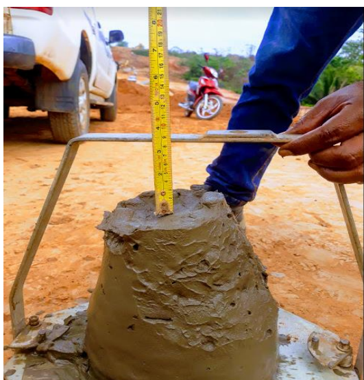
Figura 3.12 Asentamiento del hormigón fresco
