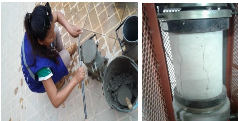
Figura 3.13 Ensayo de resistencia a la compresión
