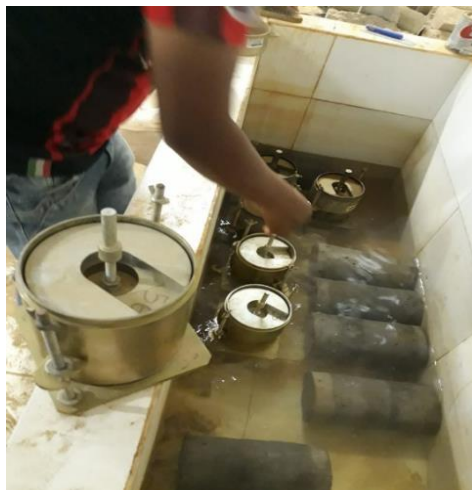
Figura 3.6 Ensayo de CBR (California Bearing Ratio)
