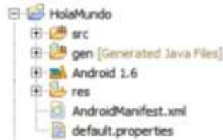
Figura 15: Estructura de un proyecto Android Fuente: (sgoliver, 2012)
