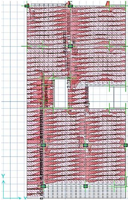
Fuente Propia: Diagramas de cortantes de viguetas (EJE X)
