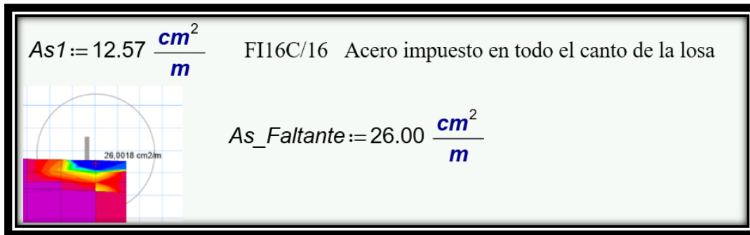
Figura 63. Área de Acero Faltante
