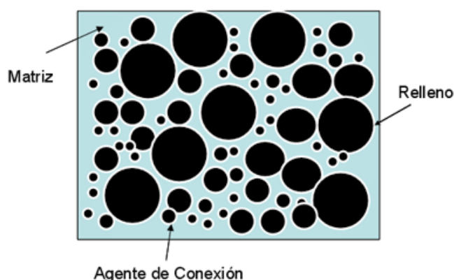
Fig. Nº 2. Componentes fundamentales de las resinas compuestas. Esquema general donde puede verse la matriz de resina, las partículas de relleno y el agente de conexión.
