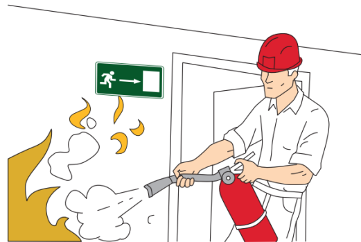
Figura 35 Forma de disparo del extintor hacia el fuego.
