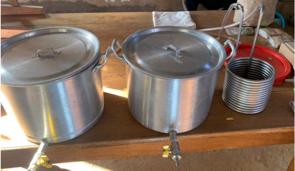
Maceradores con filtro de enfriamiento
