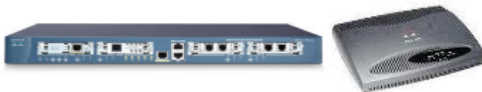
Ilustración 8 Router Cisco 1760 – 1600 Fuente: (Estrada, 2016)
