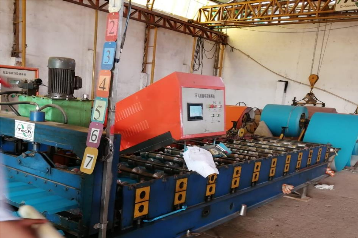
Figura 8. Maquina dobladora y cortadora tipo ondulada.
