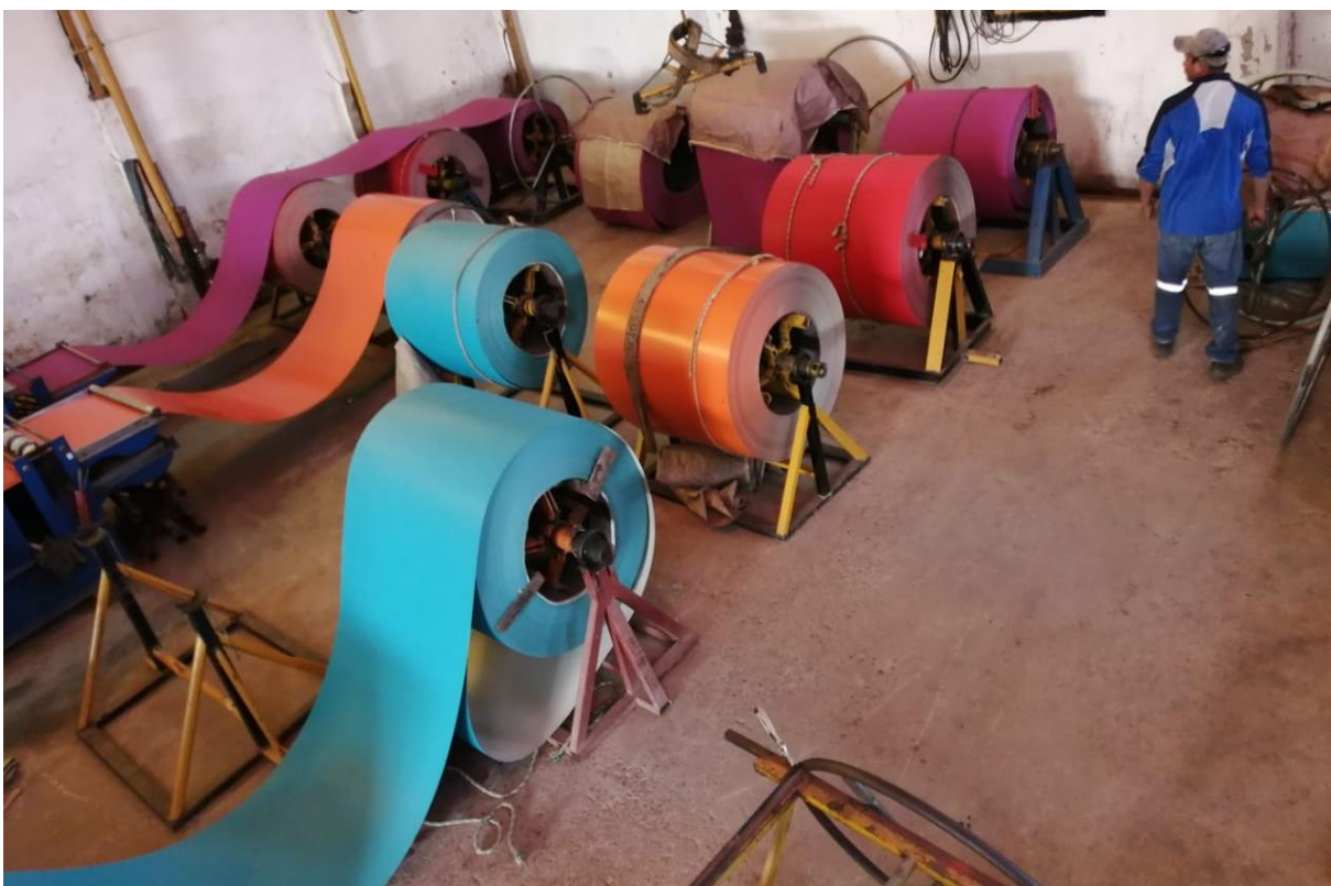
Figura 3. Plancha textual izado y pre pintado (áspero y lizo) de color rojo, naranja, amarillo, púrpura y turquesa, con espesor de 0,35 x 1000 mm #28
