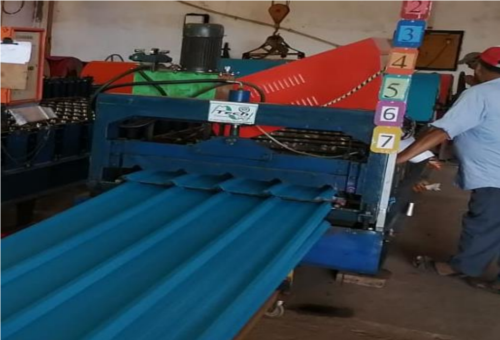
Figura 6. Maquina dobladora y cortadora tipo trapezoidal Fuentes: imágenes de la máquina de la fábrica de calaminas TECH PANDO
