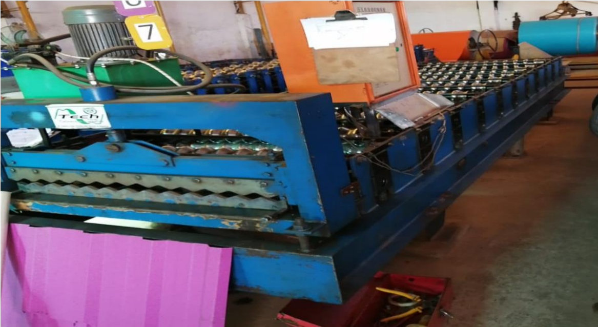
Figura 7. Maquina dobladora y cortadora tipo teja americana
