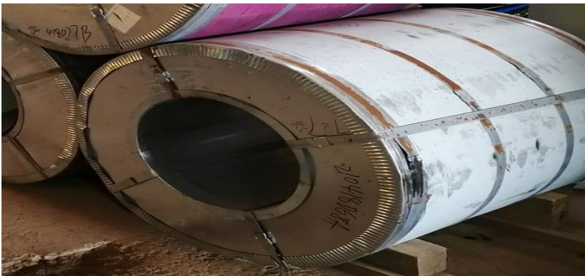
Figura 2. plancha zinc alum con espesor de 0,36 x 1000 mm #28
