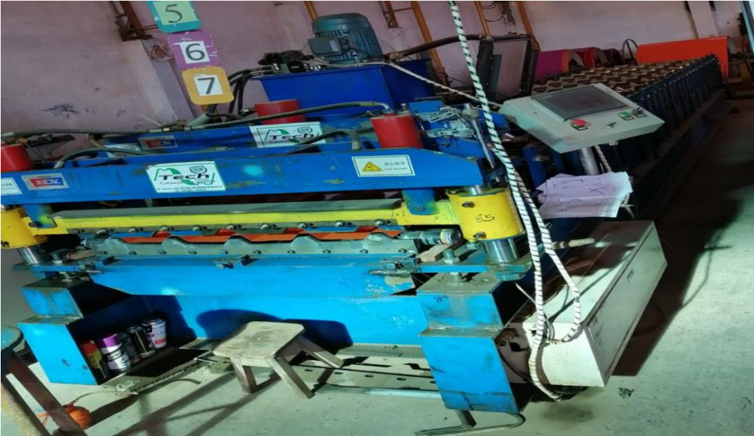
Figura 5. Maquina cortadora y dobladora tipo teja colonial Fuentes: imágenes de la máquina de la fábrica de calaminas TECH PANDO
