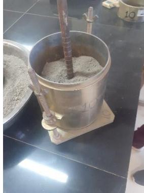
Figura 25 Compactando el agregado
