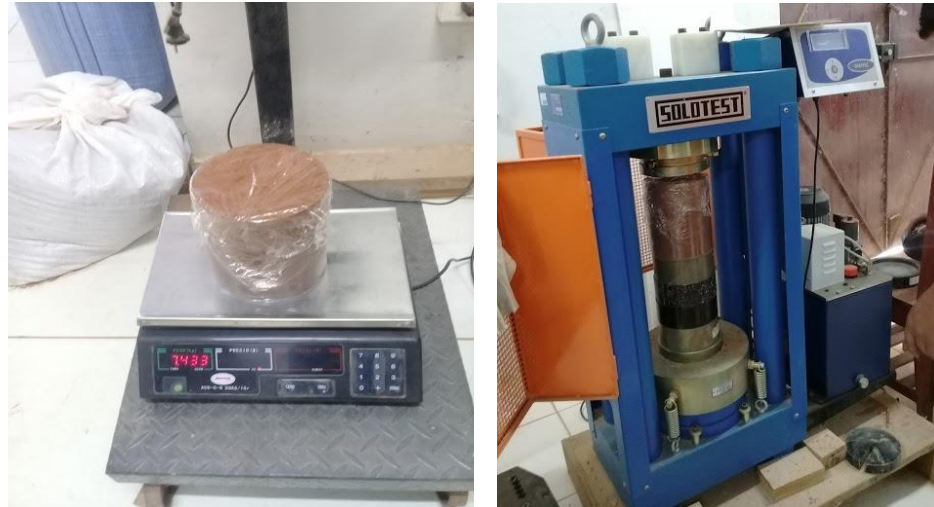
Figura 3.9 Rotura de cilindros de suelo cemento
