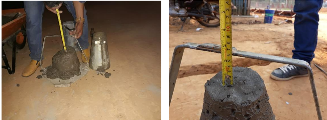
Figura 3.14 Ensayos de consistencia del hormigón
