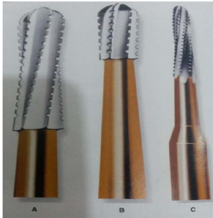
Figura 2.8 - Fresas para metal: A. cilíndrica. B. piriforme. C. cónica(Fuente: Soares & Goldberg, 2012, pp.:350)
