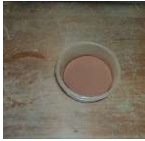
Figura.F.26. La muestra que pasa por el tamiz N°40 Fuente: Propia
