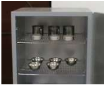
Figura.F.14. Se coloca la muestra en el horno por 24 horas
