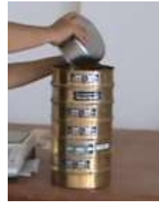
Figura.F.18. Se vacía la muestra a los tamices Fuente: Propia
