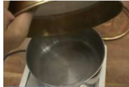
Figura.F.20. Se pesa la muestra retenida en cada y tamiz Fuente: Propia
