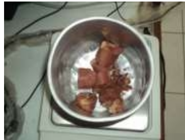
Figura. F.16. Peso del recipiente + muestra seca (W3) Fuente: Propia
