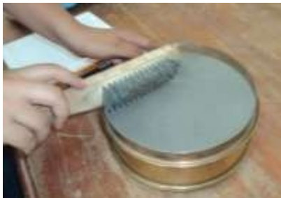
Figura.F.21. Se limpia con un cepillo metálico Fuente: Propia
