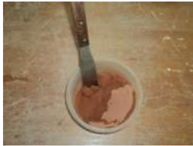
Figura.F.28. Mezcla de la muestra con agua Fuente: Propia
