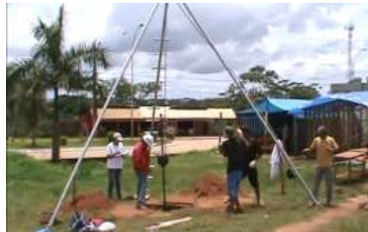
Figura.E.2. Casa de la Interculturalidad (izq), Ensayo SPT (der) Fuente: Propia
