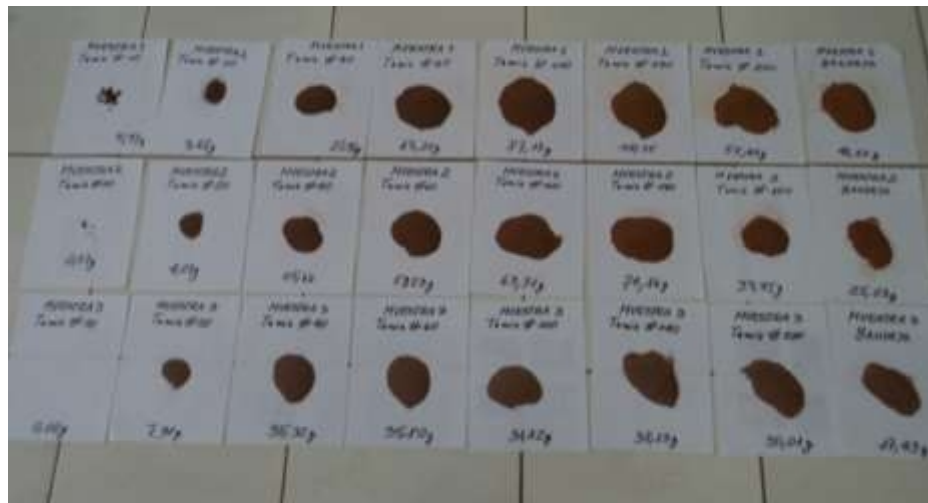
Figura.F.25. Muestras de suelo que pasa por los diferentes tamices
