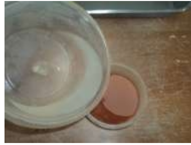
Figura.F.27. Mezcla de la muestra con agua Fuente: Propia
