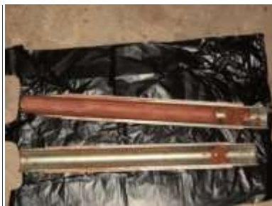
Figura. F.8. Cuchara partido con muestras Fuente: Propia
