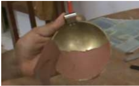
Figura.F.35. Muestra colocada en la cuchara de Casagrande
