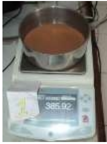
Figura. F.17. Se pesa la muestra total Fuente: Propia
