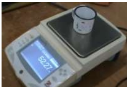
Figura.F.39. Se pesa recipiente + muestra húmeda
