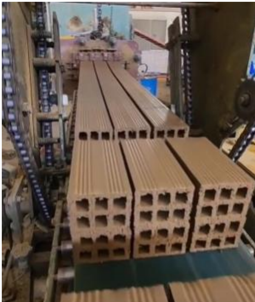
Figura 4. Corte de ladrillos Fuente: Elaboración propia.
