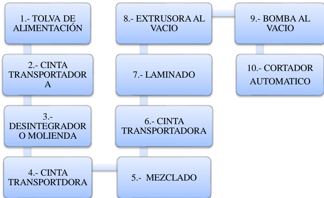
Figura 4.16 Detalle de la maquinaria
