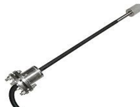
Gráfico 53: Sensor de humedad PCE-MWM 240B. Fuente: (pce).
