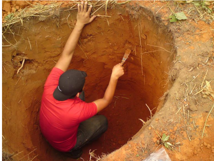
FIGURA 20. Obtención de muestras alteradas. Calicatas.
