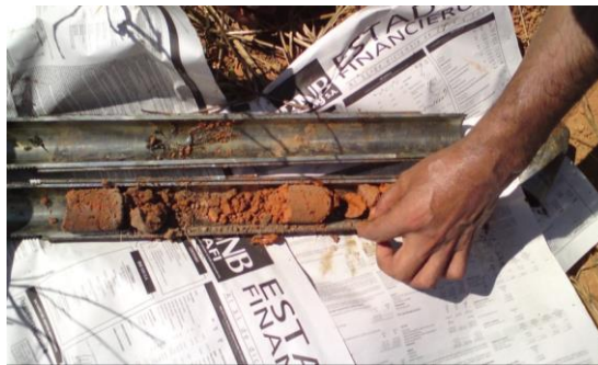
FIGURA 29. Muestra alterada testigo obtenida mediante el ensayo de SPT.
