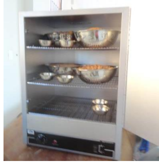
FIGURA 30. Muestras representativas de las calicatas para la obtención del contenido de humedad. Horno lab. 110°C.
