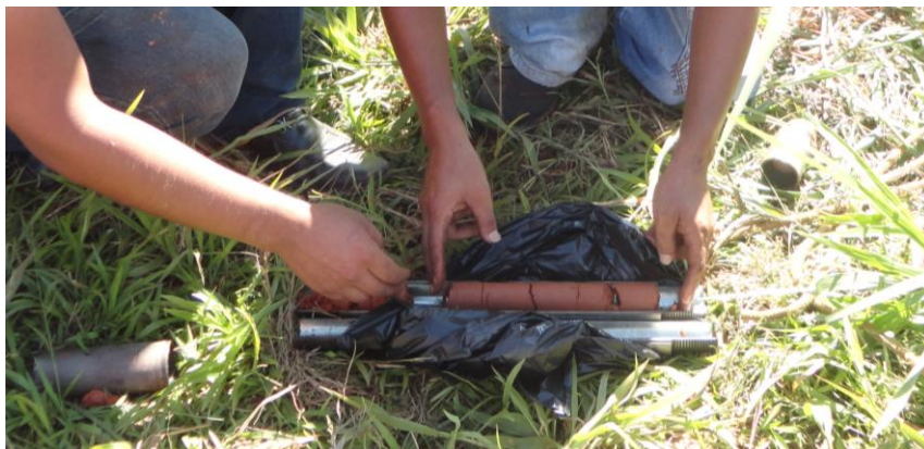
FIGURA 17. Obtención de muestras testigos del suelo mediante el ensayo SPT.
