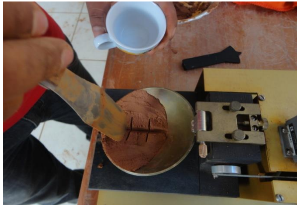
FIGURA 32. Obtención de muestra para límites de consistencia. Aparato de casa grande.
