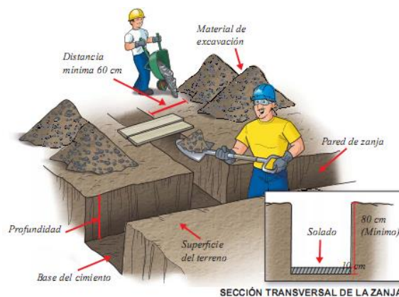
FIGURA 66. Actividad constructiva excavaciones de fundación.
