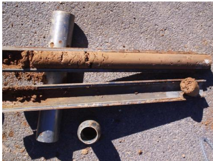
FIGURA 21. Obtención de muestras inalteradas. Sondeo ensayo de penetración estándar.
