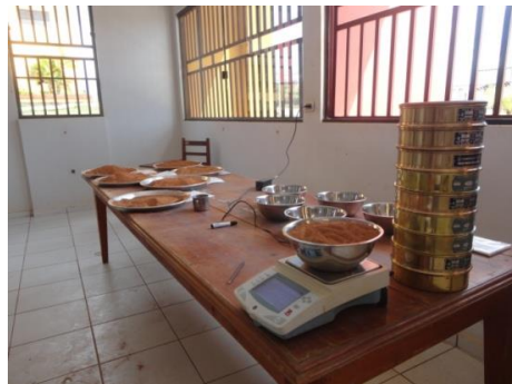
FIGURA 31. Determinación del peso masa de muestra de ensayo para el tamizado. Balanza de precisión 0.01g.
