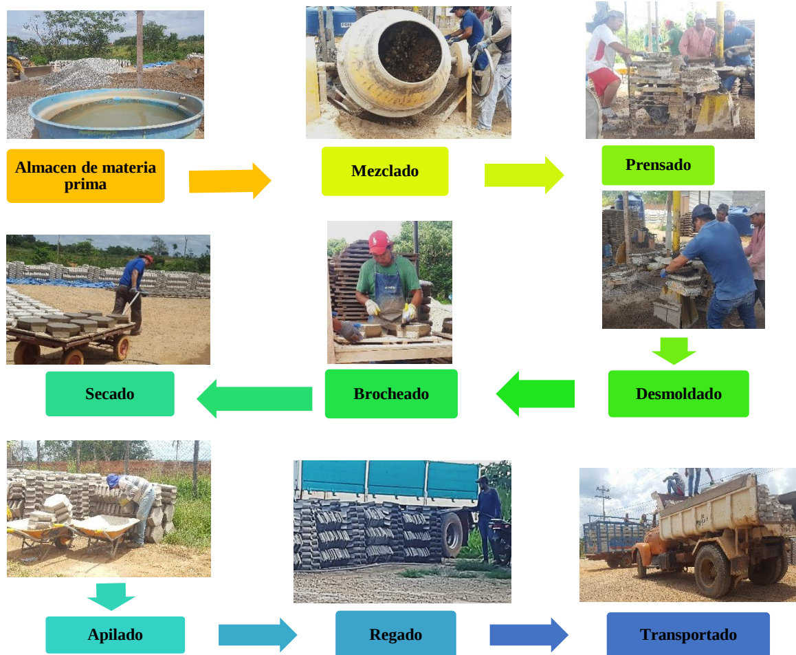
Figura 10. Diagrama del proceso productivo de losetas hexagonales.
