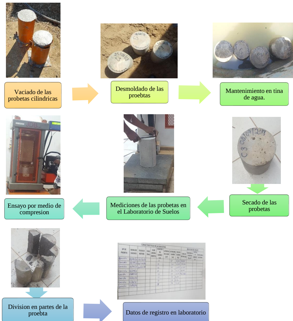
Figura 22. Diagrama del proceso del ensayo de compresión.
