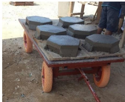
Figura 39. Después de la implementación del cambio del carrito cargador de losetas.
