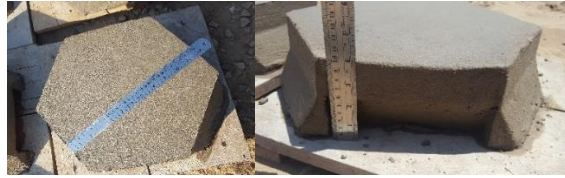
Figura 24. Medición de diámetro y altura de la loseta.
