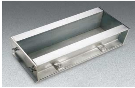
Figura 3. Molde para viga.
