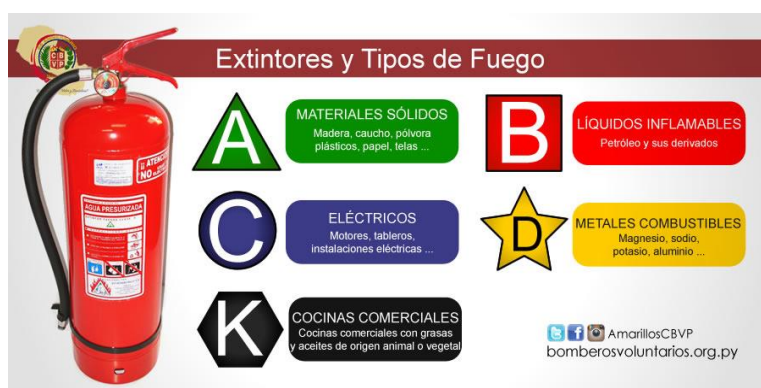
Figura 27 Tipos de extintores Fuente: Imágenes google (2017)
