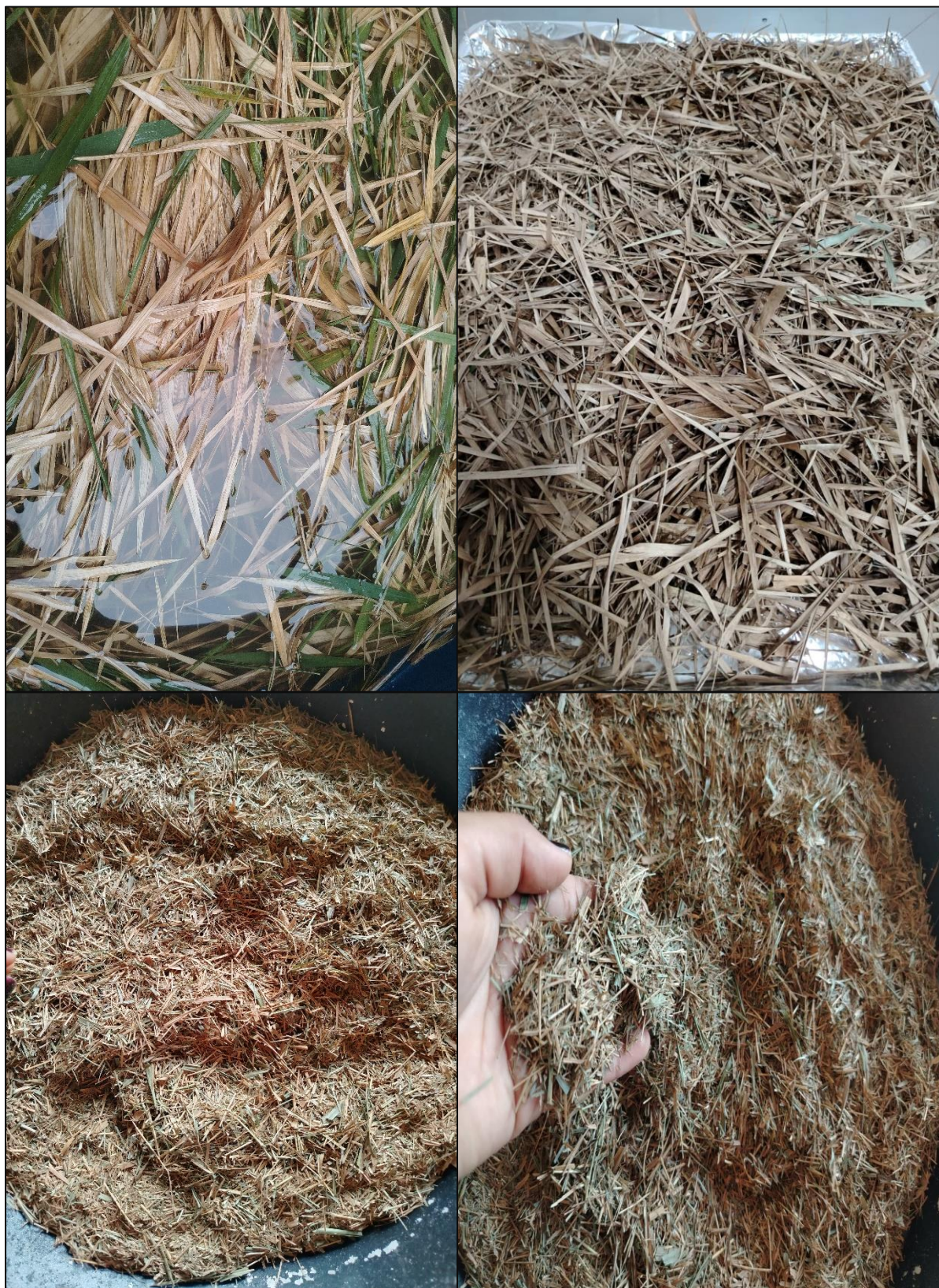
Figura B28. Limpieza, secado y trituración de las hojas de bambú recolectadas
