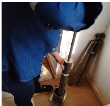
Molde Proctor modificado y martillo compactador
