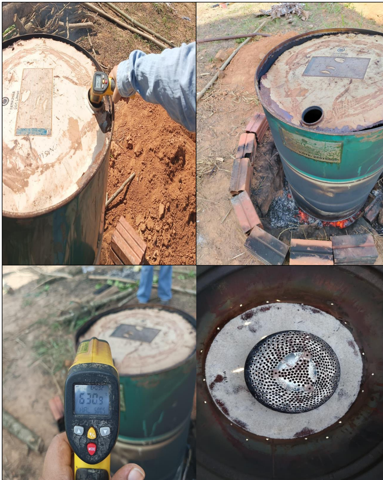
Figura B29. Proceso de calcinación controlada de hojas de bambú
