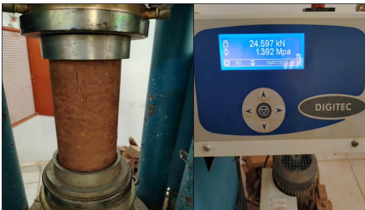
fallada tras el ensayo de compresión a 7 días – 6% CHB
