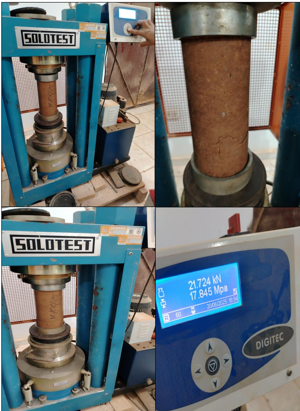
Figura D35. Probeta fallada tras el ensayo de compresión a 7 días – 2% CHB
