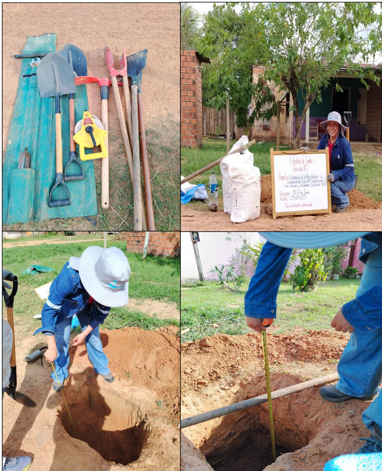
Figura A22. Recolección de muestras de suelo mediante calicatas.
