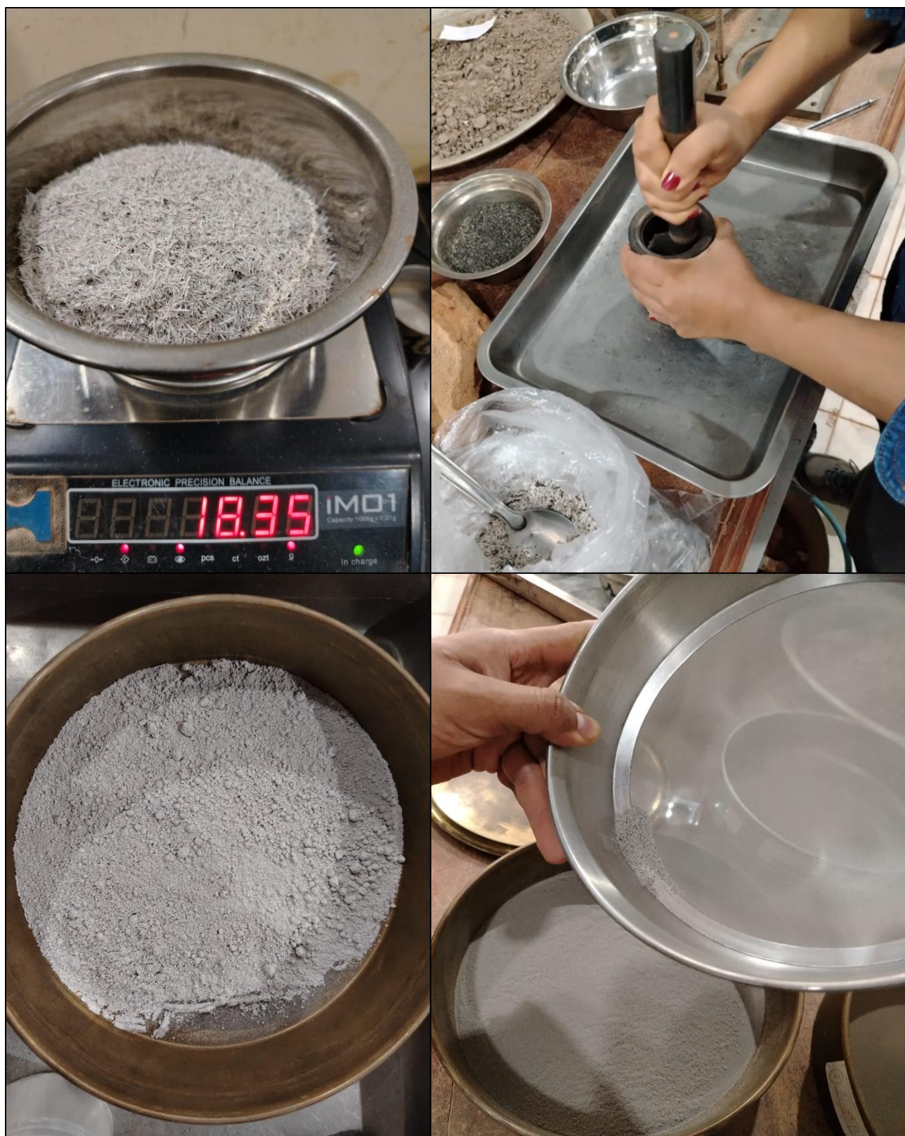
Figura B30. Ceniza de hoja de bambú obtenida y tamizada para uso en mezclas
