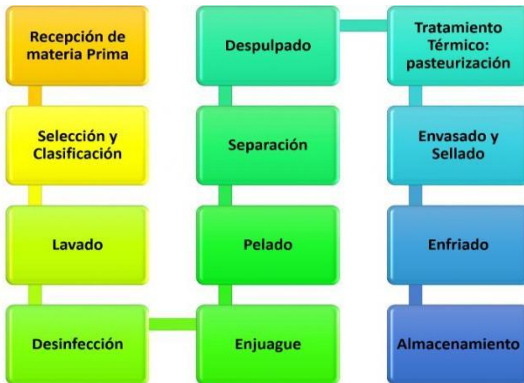
Figura 5 proceso de producción de la pulpa de asaí. Fuente http://m.zonaeconomica.com/pulpa-asaí .
