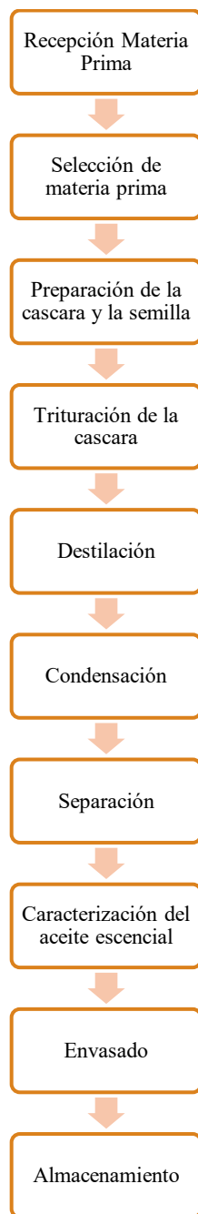
Figura 29. Diagrama del Proceso de producción aceite esencial de mango
