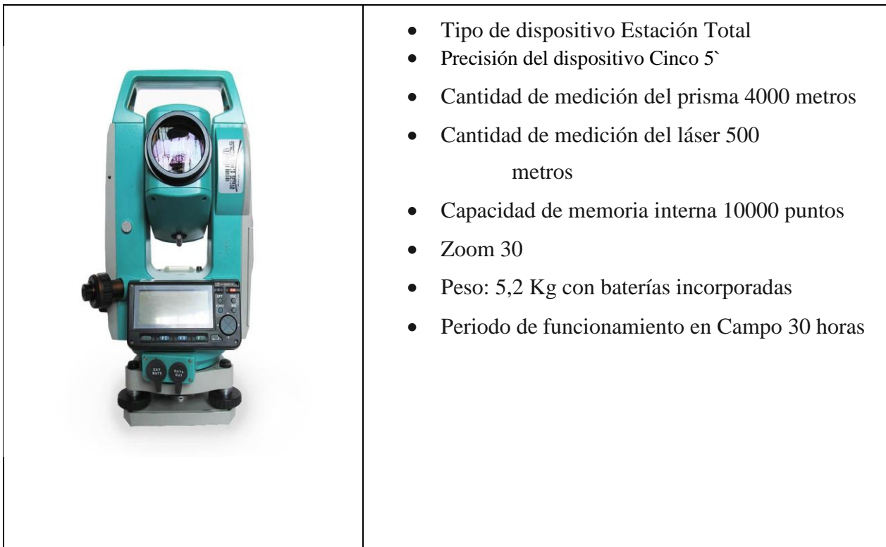
FIGURA 4. 1 Estación total – SOKKIA Set 510
