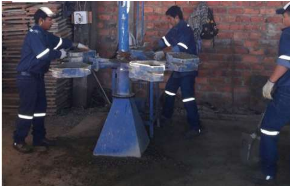
Figura 40. Producción de losetas hexagonales Fuente: Elaboración propia
