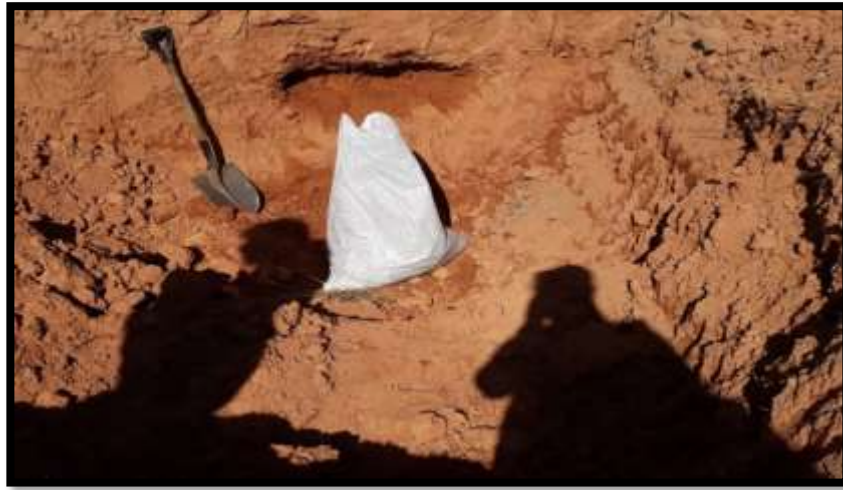
Figura 50. Extracción de muestra banco de ripio. Fuente: Elaboración propia
