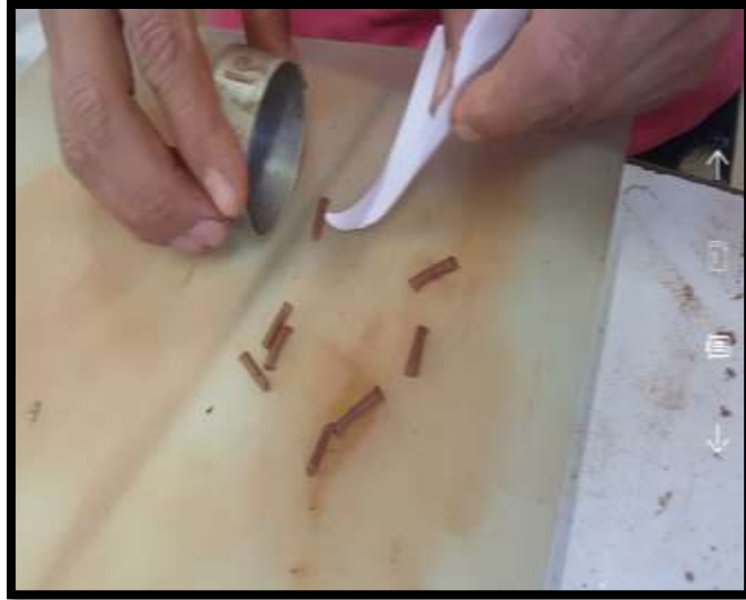
Figura 55. Elaboración de los rollitos para determinar el límite plástico Fuente: Elaboración Propia.
