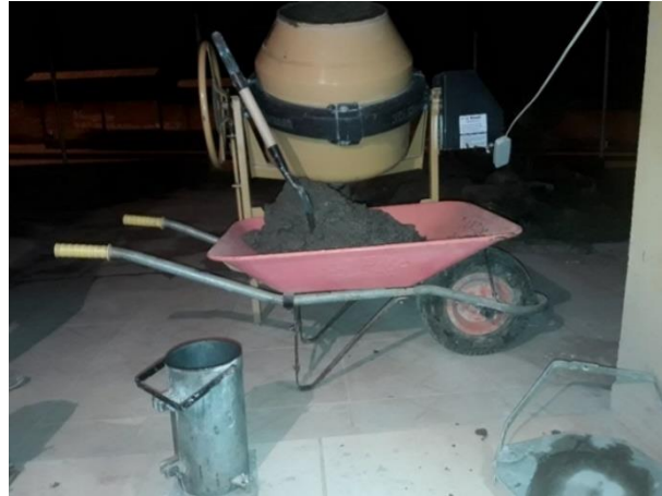
Figura 3. 40 Proceso de colocado de hormigón en moldes cilíndricos
