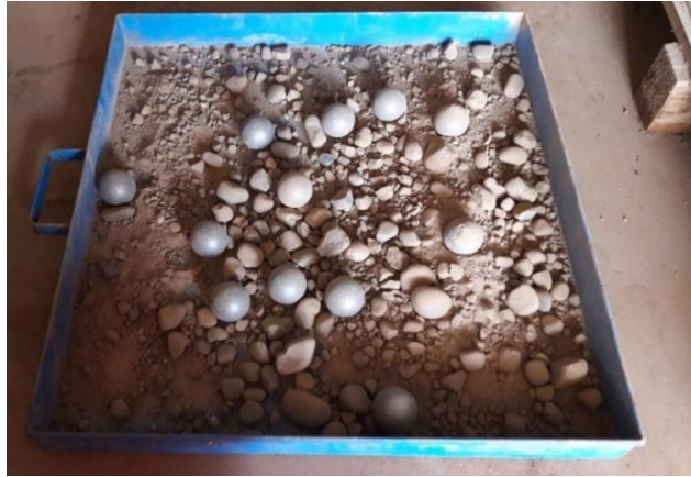
Figura 3. 21 Agregado triturado con 12 esferas metálicas Referencia: Elaboración propia
