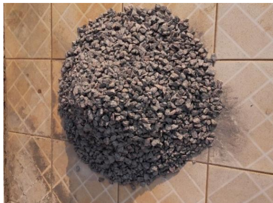
Figura 3. 6 Cuarteo de Piedra triturada del Brasil, 7/8" (brita No. 2) en proceso
