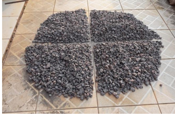
Figura 3. 7 Cuarteo manual de piedra triturada brita 2
