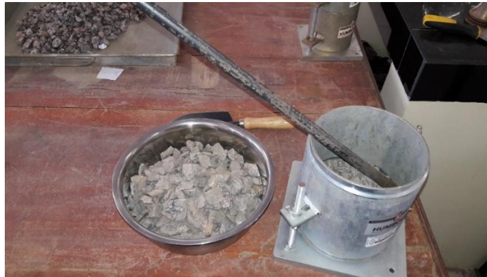
Figura 3. 25 Agregado en proceso de varillado Referencia: Elaboración propia
