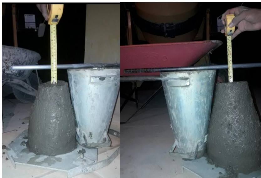
Figura 3. 39 Prueba de revenimiento
