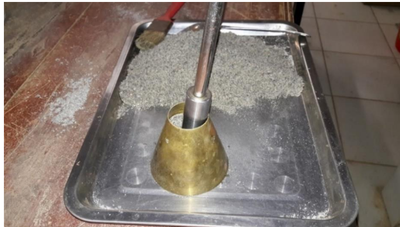
Figura 3. 16 Proceso de prueba de absorción del material fino con saturación
