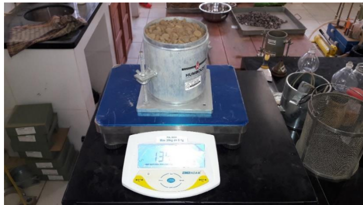
Figura 3. 26 Determinación de masa en recipiente volumétrico Referencia: Elaboración propia
