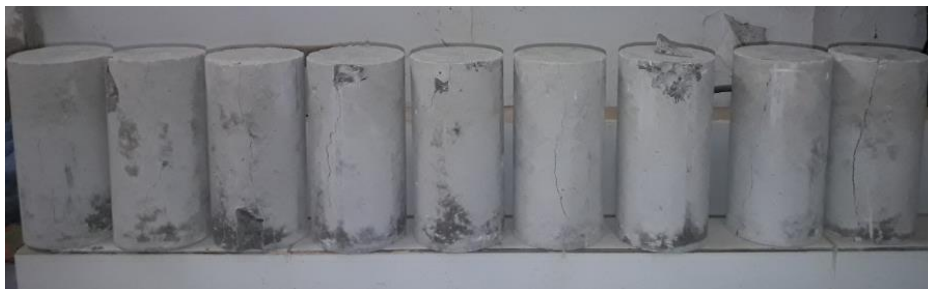
Figura 3. 42 Tipos de ruptura de los cilindros de hormigón
