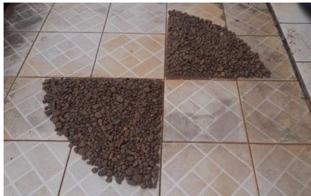
Figura 3. 8 Cuarteo manual de canto rodado del río Madre de Dios, El Sena
