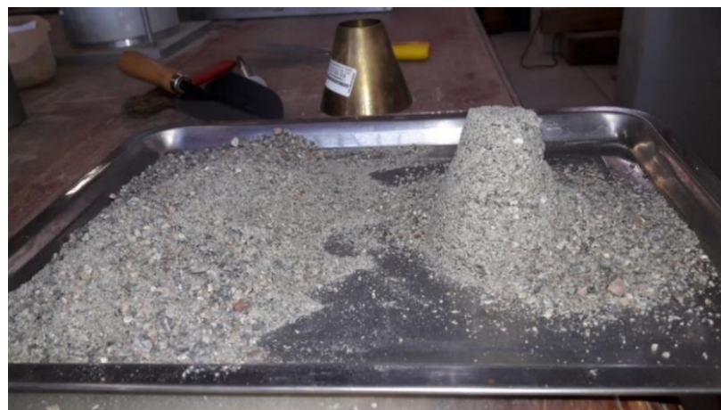
Figura 3. 17 Revenimiento, la muestra saturada alcanza la superficie seca
