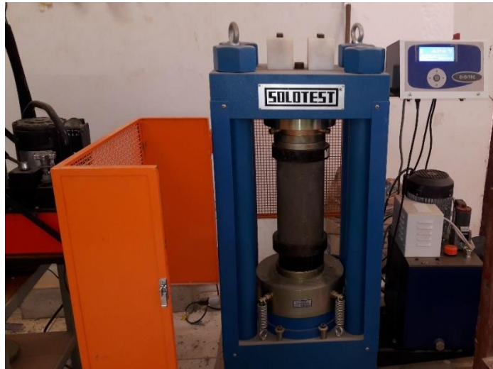
Figura 3. 43 Ruptura de cilindro de hormigón en Máquina Universal
