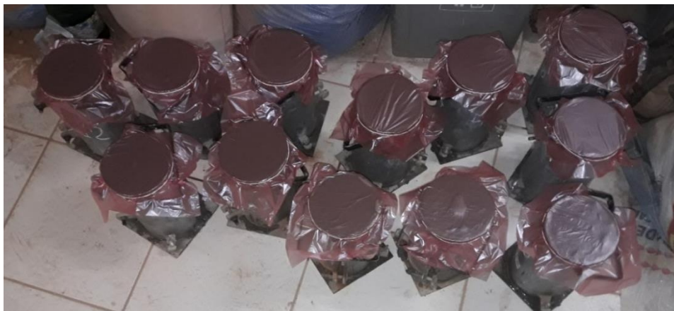
Figura 3. 41 Especímenes cilíndricos de hormigón protegidos contra la evaporación
