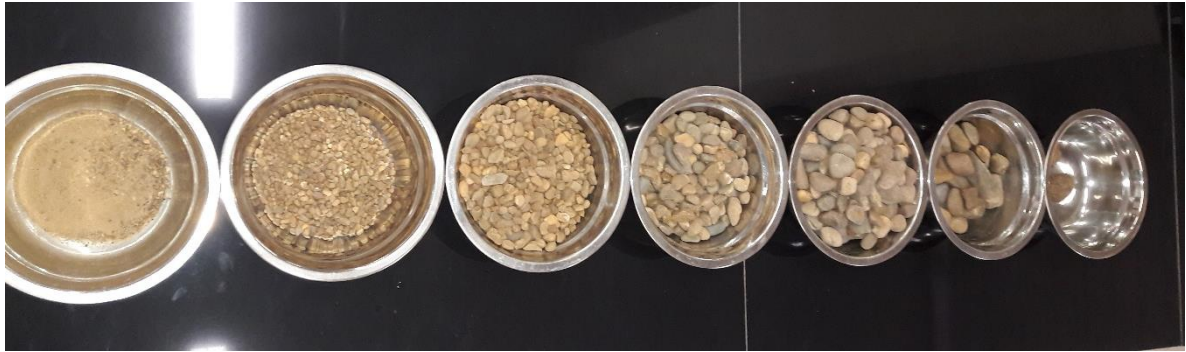
Figura 3. 30 Muestra retenida en los tamices: bandeja, No 8, No 4, 3/8", 1/2", 3/4", 1" Referencia: Elaboración propia
