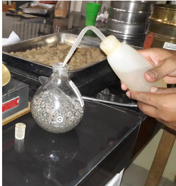
Figura 3. 18 Introducción de la muestra más agua en el picnómetro
