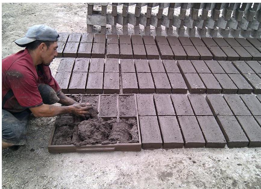
Moldado de los ladrillos artesanales para un pr- secado
