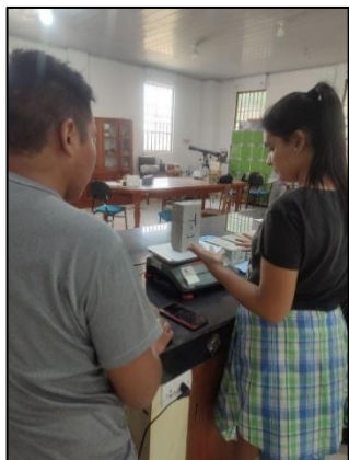
Determinación del peso de los ladrillos ecológicos por tratamientos en laboratorio
