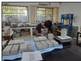
Prueba de presión de los ladrillos en laboratorio
