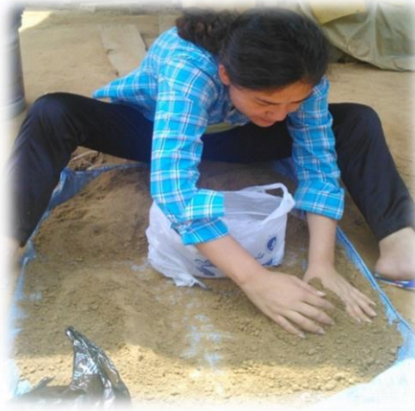
Fotografía N° 3 Cuarteo de suelo
