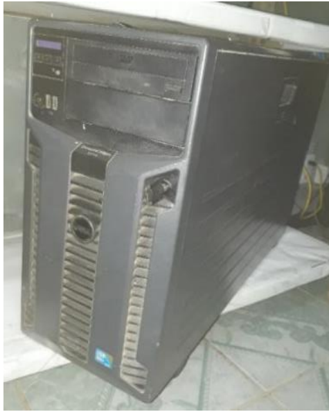
Figura 3.14 Servidor POWER EDGE T710 Fuente: Elaboración propia
