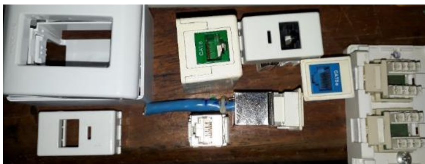
Figura 3.11 Rosetas de superficie Fuente: elaboración propia
