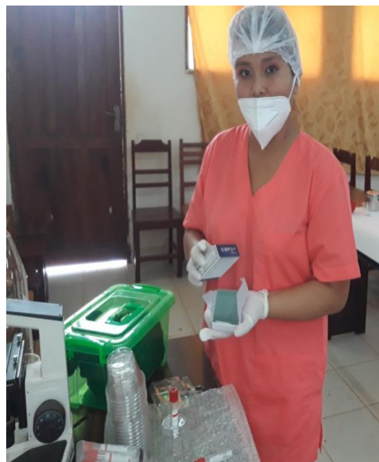
Foto 3. Desarrollo del prueba de laboratorio de heces caninas para determinar los helmintos gastrointestinales. (Técnica de Flotación Directa de Willis) Materiales coproparasitario
