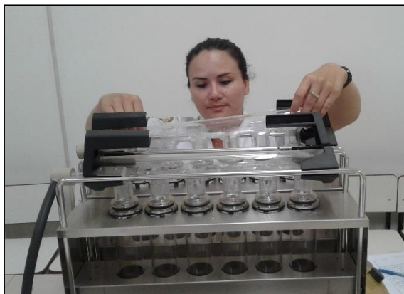
Figura 31 Determinación de la cantidad de Nitrógeno presente en las muestras.
