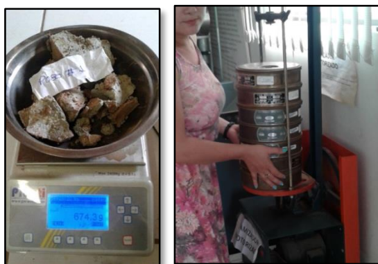
Figura 37 Peso de la muestra representativa y tamizado
