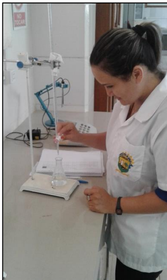
Figura 30 Ensayo para la determinación de Materia Orgánica en la Arcilla
