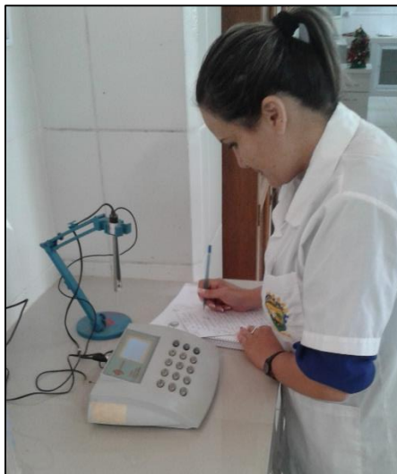
Figura 29 Medición de la Conductividad Eléctrica de la Arcilla.
