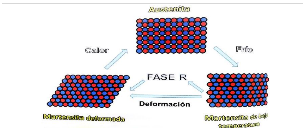
Figura 3: Esquema que demuestra la deformación de la aleación NiTi con el aumento de la temperatura.
