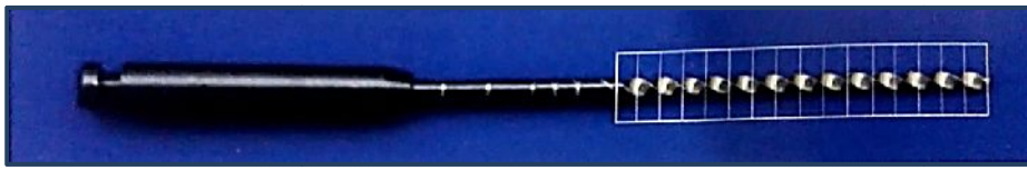
A: Instrumento RBS, ejemplo de pitch constante
