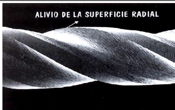
Figura 12: Alivio de la superficie radial del instrumento KENDO. 100x.
