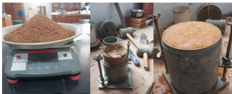
Imagen 27 Proctor modificado del suelo natural
