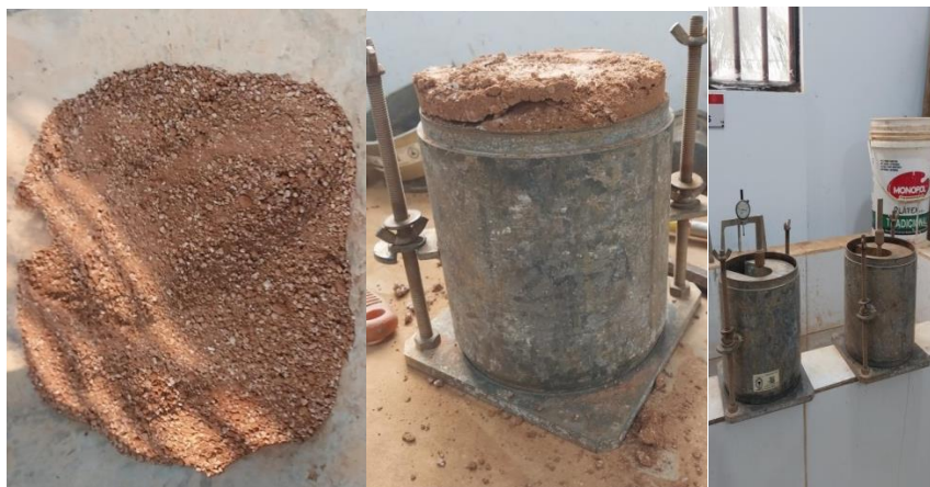
Imagen 28 Ensayo de C.B.R.
