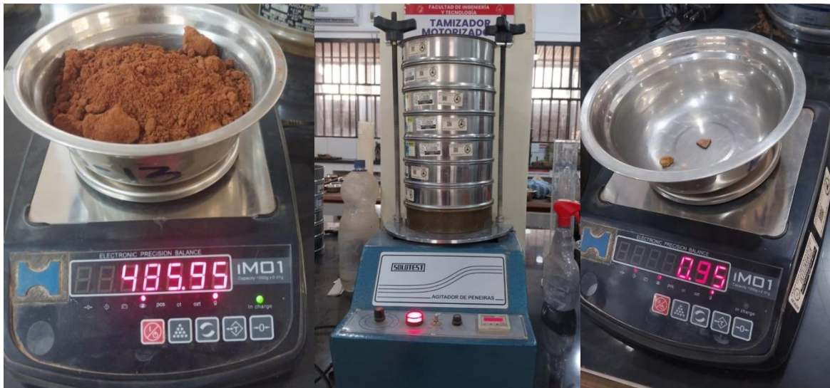
Imagen 25 Clasificación de suelo granulometría
