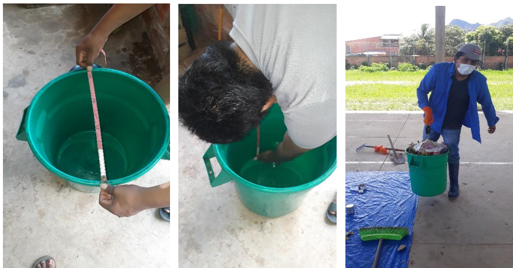
Imagen 24: Medición del recipiente y pesaje, para determinar el peso volumétrico
