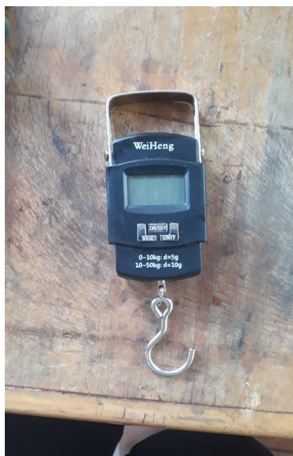
Imagen 25: Balanza electrónica portátil (capacidad de 50 Kg), utilizada para el pesaje de los residuos sólidos
