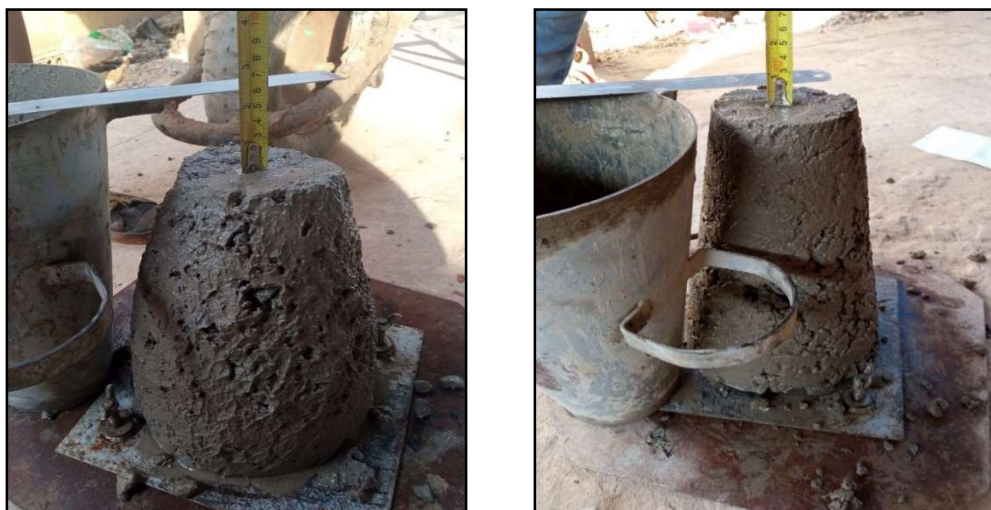
Figura 34 Ensayo determinación de revenimiento ASTM C 143
