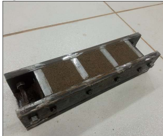
Especímenes cúbicos de (50 X 50 X 50) mm
